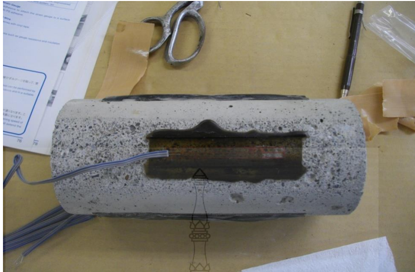
ภาพที่ 2.6 การติดตั้ง Strain Gauge ชิ้นงานคอนกรีต
