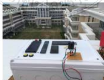
รูปที่ 6 การวัดความเข้มแสงอาทิตย์จากแผงโซลาร์เซลล์ที่มีแรงดันไฟฟ้าขนาด 3 โวลต์ 5 โวลต์ และไพรานอรัมิเตอร์
