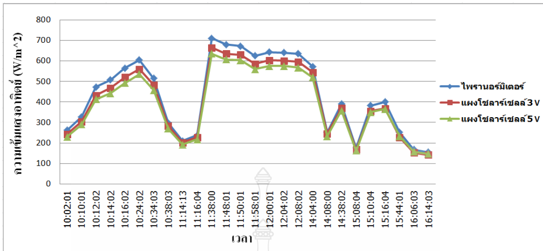
รูปที่ ก.9 กราฟเปรียบเทียบค่าความเข้มแสงอาทิตย์ที่วัดได้จากแผงโซลาร์เซลล์และไพรานอร์มิเตอร์
