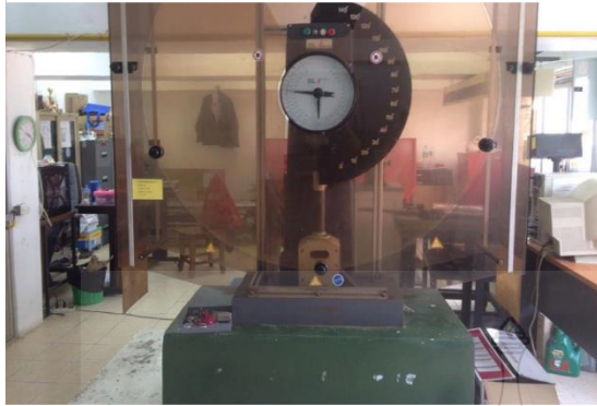
รูปที่ 3.9 เครื่องทดสอบความแข็งแรงกระแทก และตำแหน่งการทดสอบ
