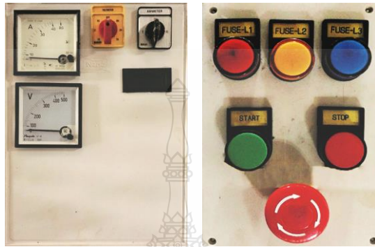
รูปที่ 2.6 ชุดกล่องควบคุมเครื่องย่อยทางปาล์ม [11]
