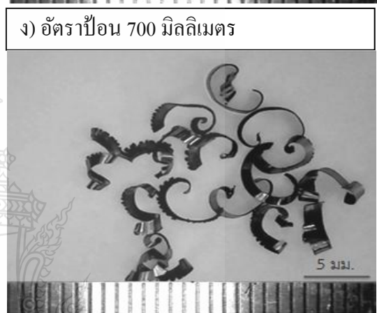
รูปที่ 4.16 ลักษณะของเศษตัดภายใต้เงื่อนไขอัตราป้อน ที่ความเร็ว 1100 รอบ/นาที และความลึก 1 มิลลิเมตร
