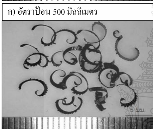
รูปที่ 4.16 ลักษณะของเศษตัดภายใต้เงื่อนไขอัตราป้อน ที่ความเร็ว 1100 รอบ/นาที และความลึก 1 มิลลิเมตร
