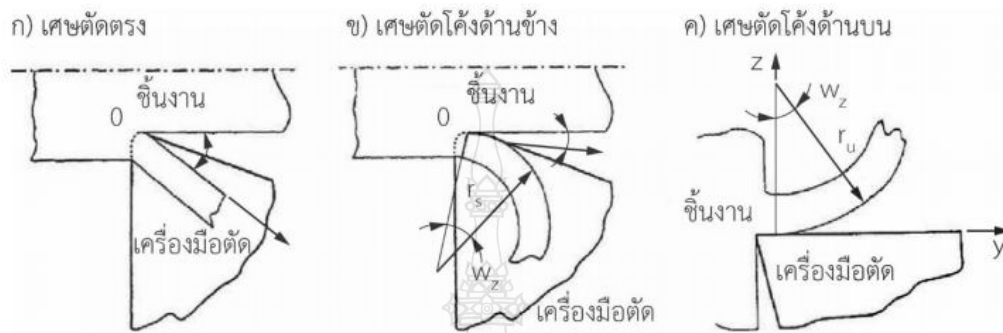
รูปที่ 2.21 ลักษณะต่างๆของการเกิดเศษตัด 3 แบบ [33]
