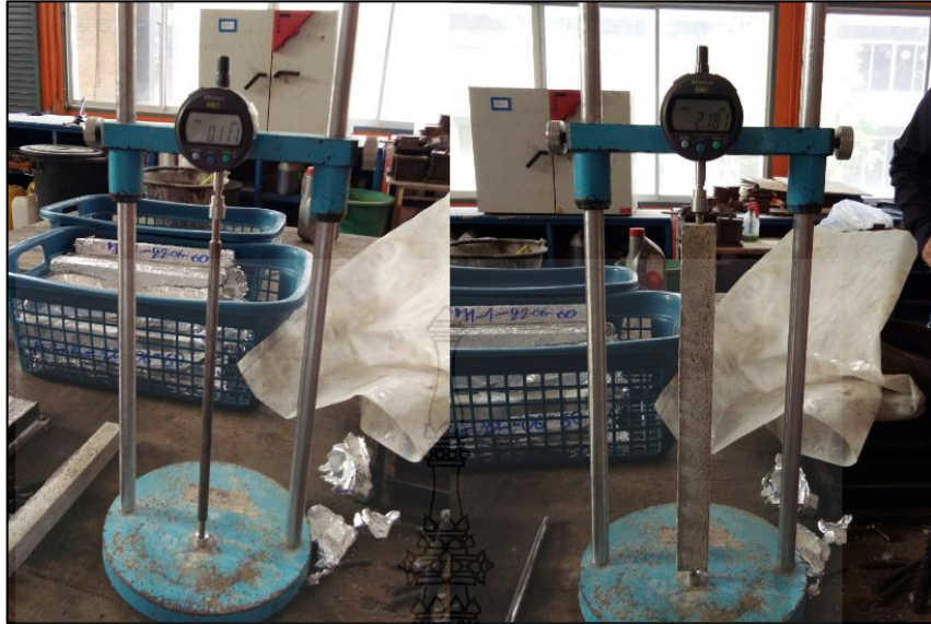
รูปที่ 3.3 เครื่องมือวัดหาค่าการหดตัว (Length Capacity) ของมอร์ตาร์ เทียบกับแท่งโลหะที่มีความยาวมาตรฐาน
