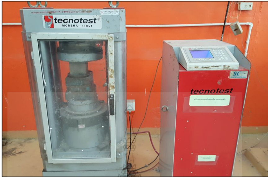
รูปที่ 3.4 เครื่องทดสอบกำลังอัดประลัย (Universal Testing Machine)
