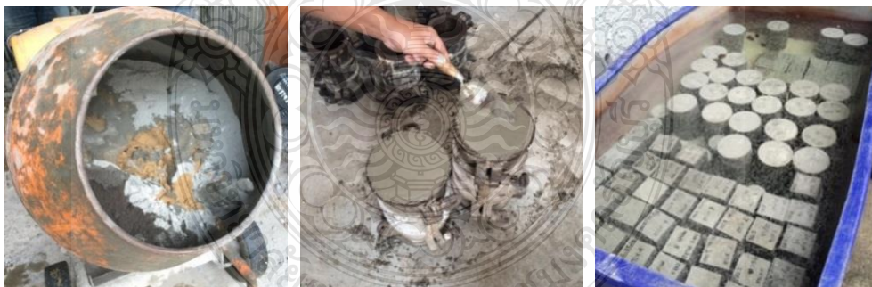
รูปที่ 3.7 การเตรียมตัวอย่างคอนกรีตที่ใช้ในการศึกษา
