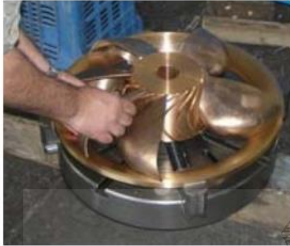
รูปที่ 2.3 กังหันน้ำเทอร์โก (Turgo Turbine) [3]
