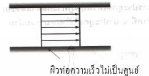
รูปที่ 2.12 ความเร็วเฉลี่ยที่เกิดขึ้นในระบบการไหลในท่อ [2]
