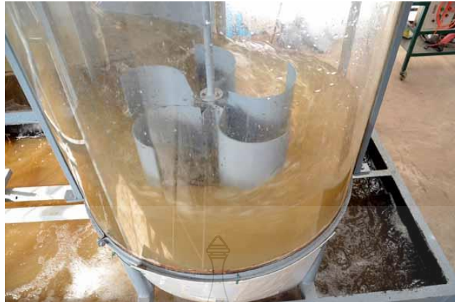
รูปที่ 2.13 ระบบผลิตพลังงานไฟฟ้าจากพลังงานน้ำวนอิสระ [1]
