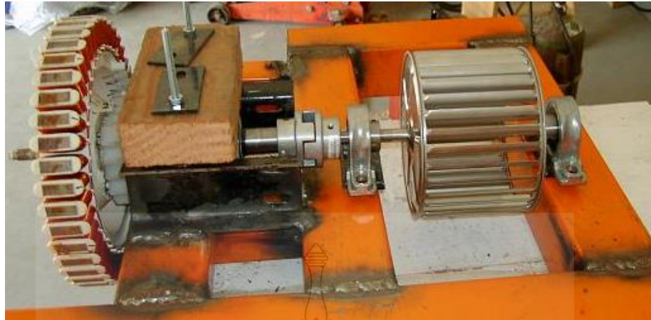
รูปที่ 2.1 กังหันน้ำเบงกี (Banki Turbine ) [1]
