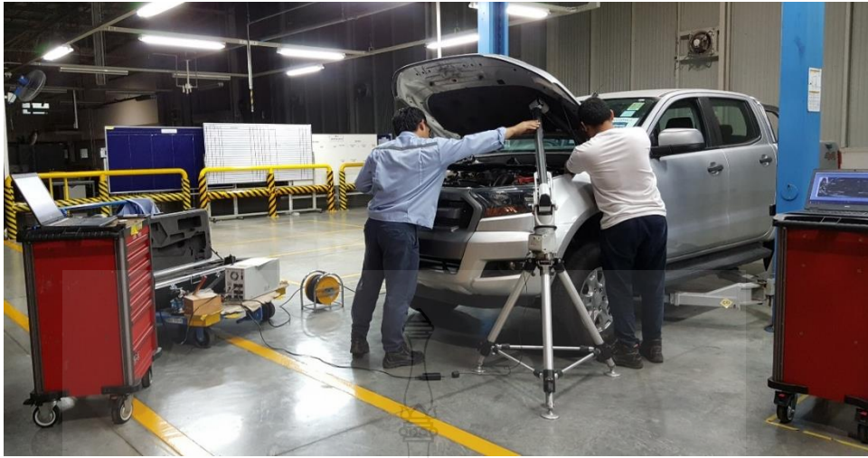
วัดจุดประกอบบนตัวรถด้วยเครื่องมือวัด 3 มิติ (CMM)
