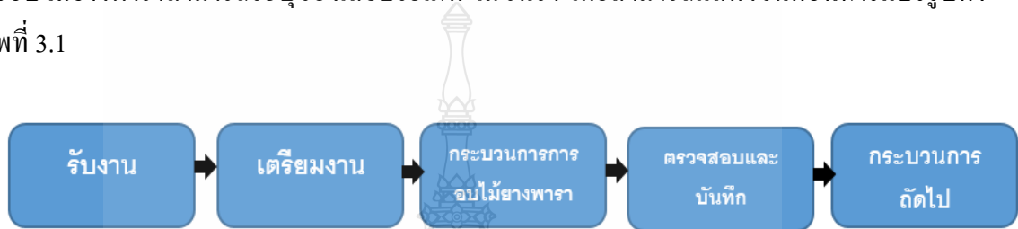
ภาพที่ 3.1 แสดงขั้นตอนการผลิตไม้ยางพาราแปรรูป สามารถจำแนกได้ดังต่อไปนี้
