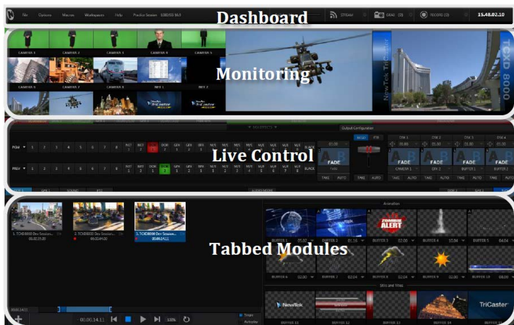
ภาพที่ 2.19 คำสั่งของส่วนต่างๆ บนหน้าจอ โดยแบ่งตามหน้าที่ของโปรแกรม TriCaster 410
