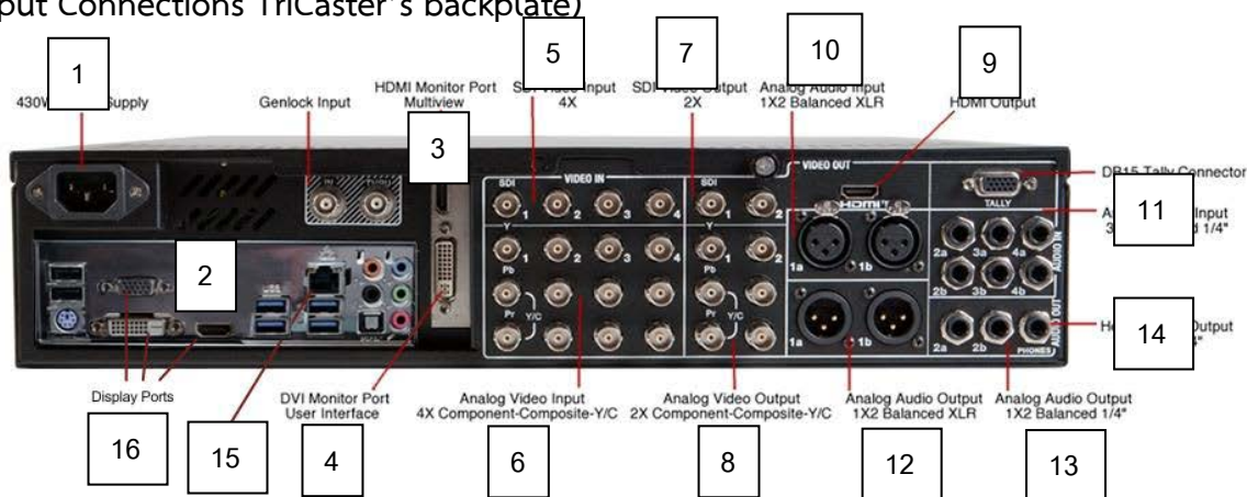
ภาพที่ 2.9 การติดตั้งและเชื่อมต่อระบบสัญญาณภาพและเสียงของเครื่อง Tri Caster 410
