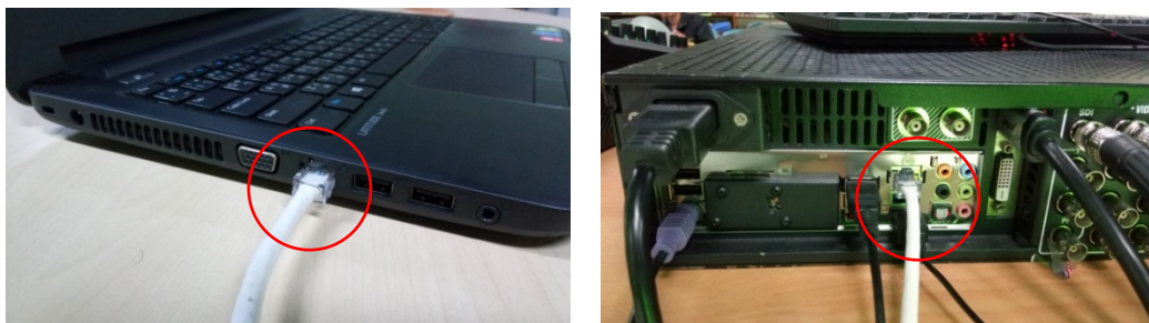
ภาพที่ 2.57 การต่อสายสัญญาณต่ออินเทอร์เน็ตที่เครื่องคอมพิวเตอร์และ Switcher
