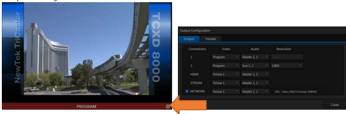
ภาพที่ 2.62 การกำหนดคุณสมบัติของไฟล์ที่จะทำการบันทึก และการ Output ภาพในรูปแบบต่างๆ
