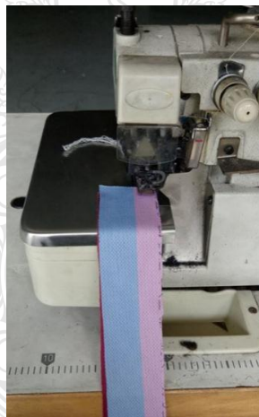
รูปที่ 3.11 วิธีเย็บชิ้นงานแบบไม่ติดป้ายการดูแลรักษาเสื้อผ้า
