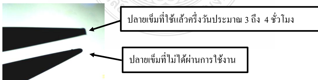
รูปที่ 2.15 เปรียบเทียบเข็มจักรที่ใช้แล้วกับยังไม่ได้ใช้
