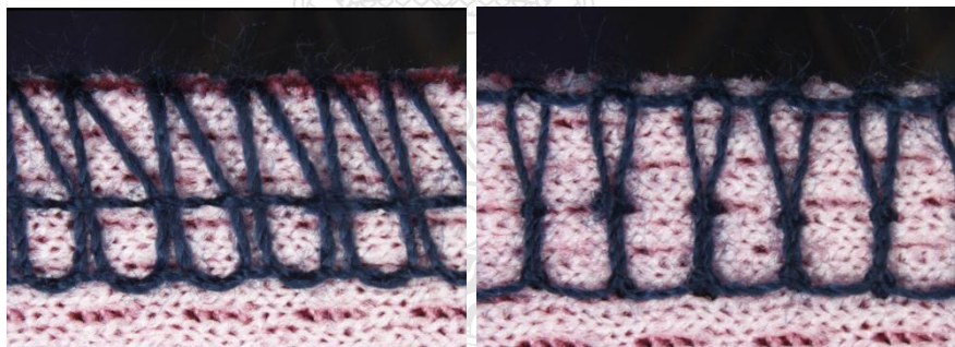
รูปที่ 3.13 ลักษณะตะเข็บเย็บพื้นริมแบบไม่ติดป้ายการดูแลรักษาเสื้อผ้า (ก) ตะเข็บด้านหน้า และ (ข) ตะเข็บด้านหลัง
