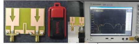
(ก) สายอากาศต้นแบบ (ข) เครื่องวิเคราะห์โครงข่ายรูปที่ 4 ภาพถ่ายสายอากาศต้นแบบจริงและเครื่องวิเคราะห์โครงข่าย
