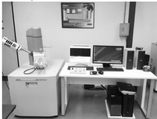
รูปที่ 3.15 การตรวจสอบส่วนผสมทางเคมีและวิเคราะห์การกระจายตัวของธาตุ
