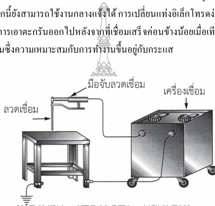
รูปที่ 2.3 อุปกรณ์การเชื่อมอาร์กลวดเชื่อมหุ้มฟลักซ์ (Shield Metal Arc Welding; SMAW) [10]
