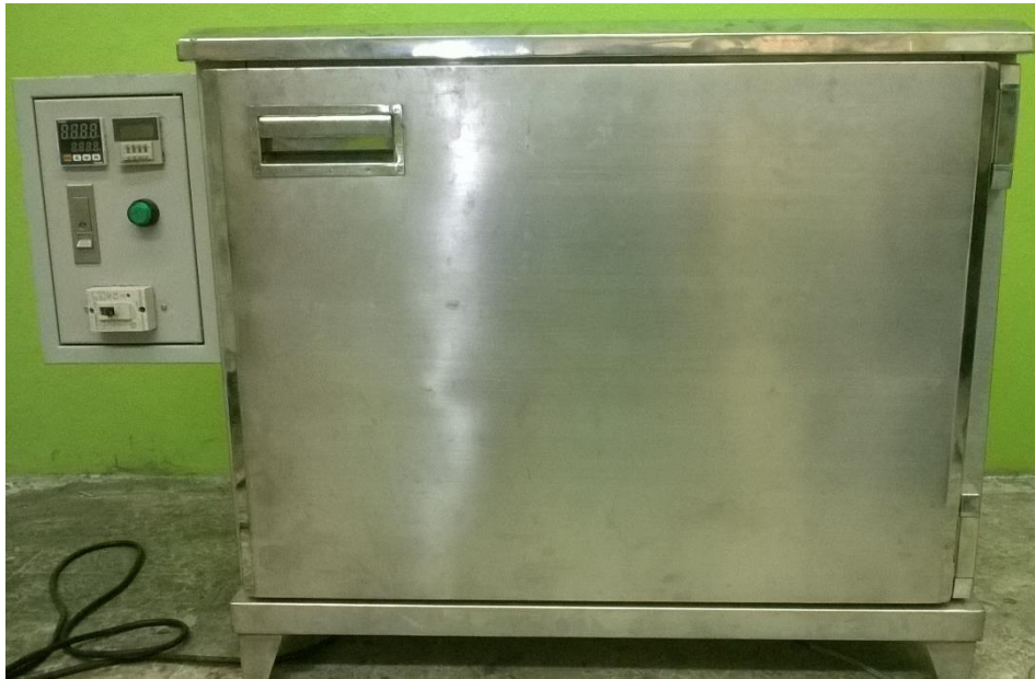
รูปที่ 2.30 ตู้บ่มสุกด้วยแสงอุลตราไวโอเลต
