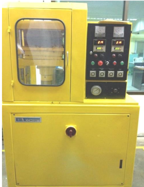
รูปที่ 2.34 เครื่องอัดแบบอัตโนมัติที่ใช้ในการอัดชิ้นงานทรงแบน
