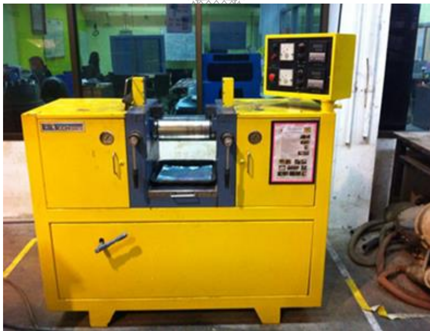
รูปที่ 2.33 เครื่องผสมแบบสองลูกกลิ้ง (Two-Roll Mill)
