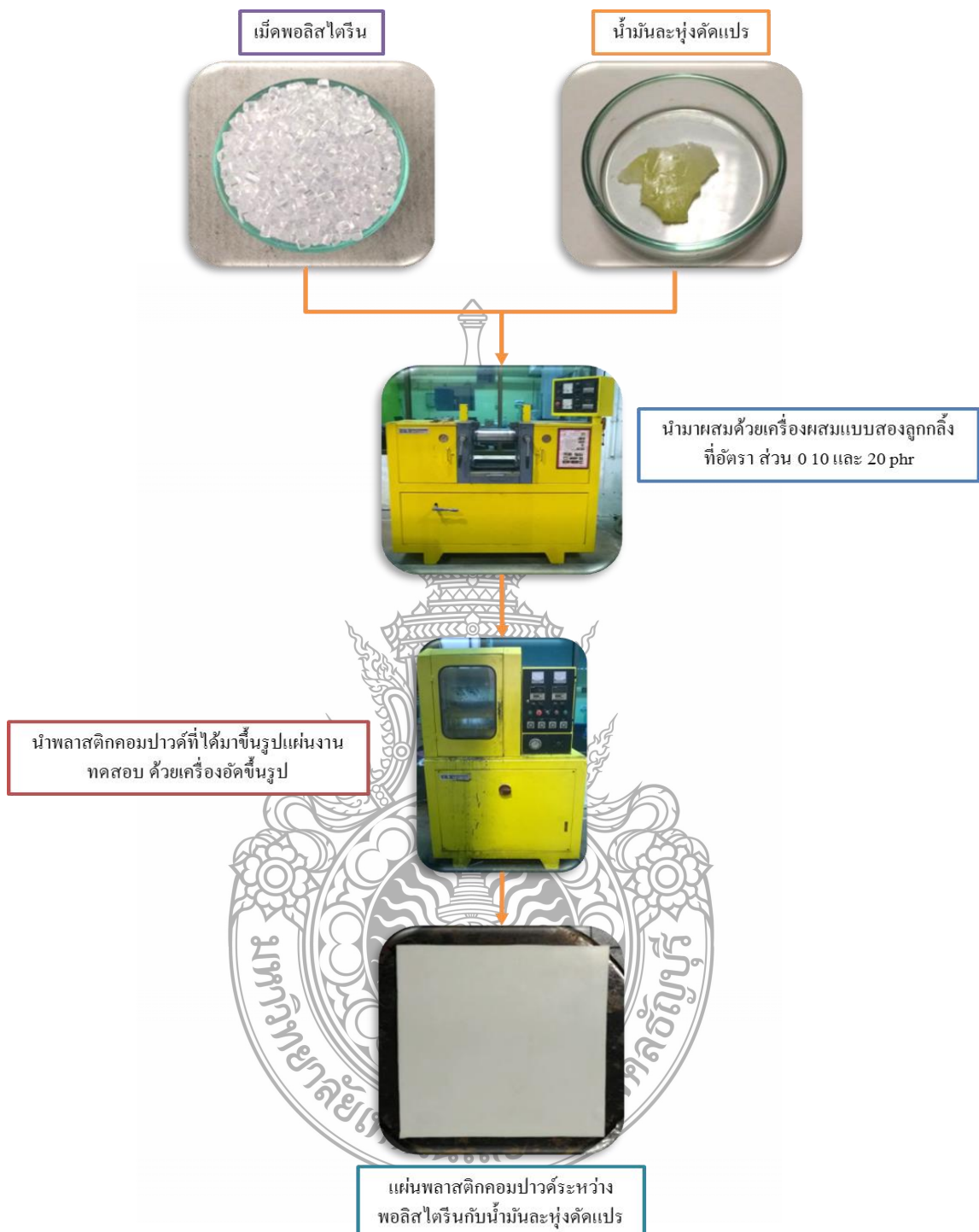
รูปที่ 3.10 แสดงขั้นตอนการทำพลาสติกคอมปาวด์และการขึ้นรูปแผ่นทดสอบของพอลิสไตรีนกับน้ำมันละหุ่งที่คัดแปร
