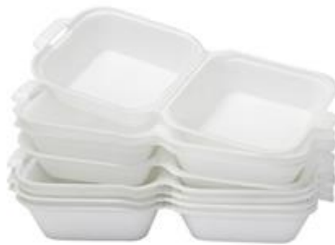
รูปที่ 2.7 แสดงรูปตัวอย่าง โฟมพีเอสพี (PSP) [50]
