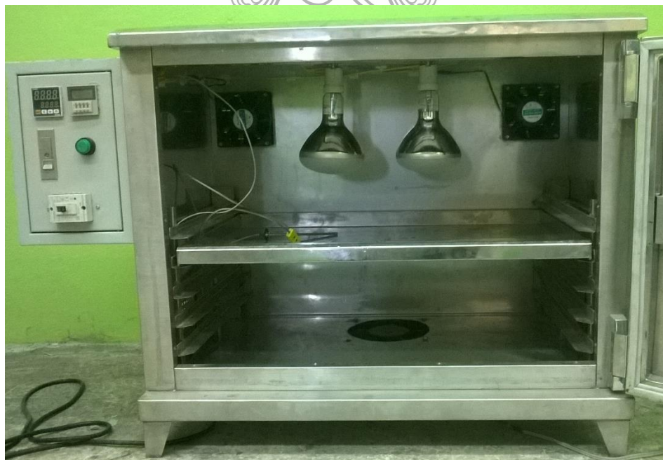
รูปที่ 2.31 แสดงการจัดวางหลอดในตู้บ่มสุกด้วยแสงอุลตราไวโอเลต
