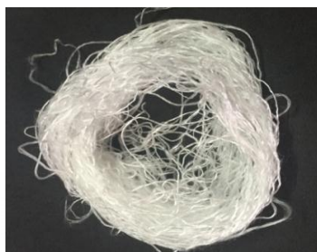
รูปที่ 3 ไหมที่ลอกกาวด้วย \text{Na}_2\text{CO}_3 2 กรัมต่อลิตร + Soap ไม่มีประจุ 10 กรัมต่อลิตร 98^\circ\text{C} x 60 นาที pH 11.5
