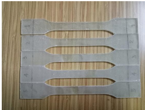
รูปที่ 3.6 ขนาดชิ้นงานทดสอบการต้านทานแรงดึง ตามมาตรฐาน ASTM D 638M
