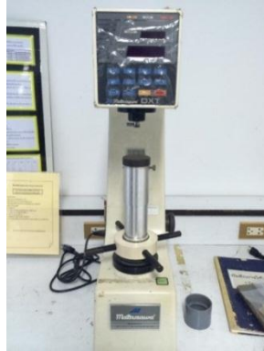
รูปที่ 3.9 เครื่องการทดสอบความแข็งแบบรอกเวล (Rockwell Hardness Test) ตามมาตรฐาน ASTM D 785
