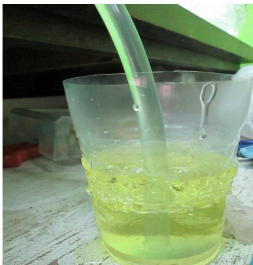
รูปที่ 4.7 แสดงถึงเวลาการกระตุ้นที่ 4 นาที อีพ็อกซีผสมมีลักษณะการเสื่อมสภาพ ทางความร้อน ที่เกิดจากการคายพลังงานความร้อน
