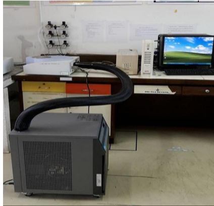
รูปที่ 3.3 เครื่องวิเคราะห์ทางความร้อนด้วยเทคนิค (Differential Scanning Calorimeter, DSC)
