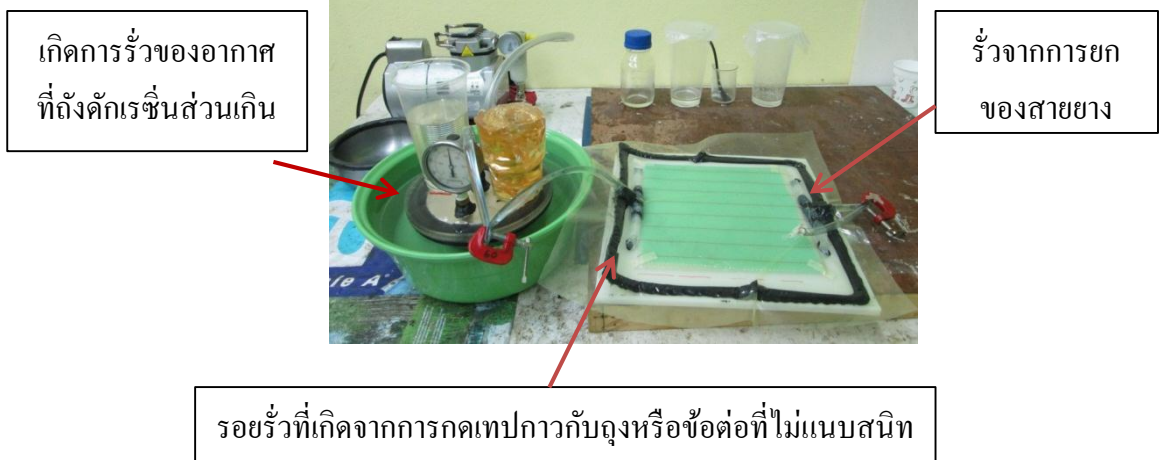
รูปที่ 4.5 แสดงบริเวณรอยรั่วส่วนใหญ่ที่เกิดขึ้นในกระบวนการขึ้นรูปแบบถุงสุญญากาศ
