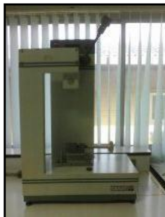
รูปที่ 3.7 เครื่องทดสอบการต้านทานแรงกระแทก (Charpy Impact Strength) ตามมาตรฐาน ASTM D 6110)
