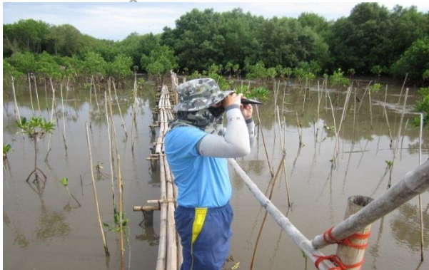
ภาพที่ 3.7 การวัดความเค็มของน้ำกร่อยพื้นที่แปลงศึกษา
