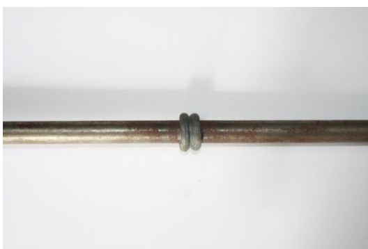
รูปที่ ก.7 ชิ้นงานที่ทำการเชื่อมด้วยความเสียดทานด้วยความเร็วรอบ 1,800 รอบ/นาทีที่เวลา 4 วินาที ความดัน 20 บาร์
