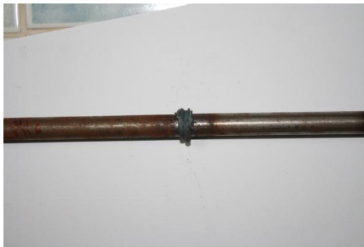
รูปที่ ก.1 ชิ้นงานที่ทำการเชื่อมด้วยความเสียดทานด้วยความเร็วรอบ 1,500 รอบ/นาที เวลา 2 วินาที ความดัน 20 บาร์
