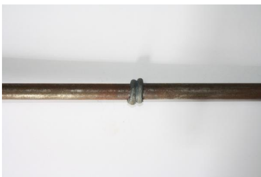
รูปที่ ก.9 ชิ้นงานที่ทำการเชื่อมด้วยความเสียดทานด้วยความเร็วรอบ 2,200 รอบ/นาทีที่เวลา 2 วินาที ความดัน 20 บาร์
