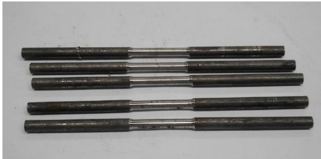
รูปที่ ก.14 ชิ้นงานกลึงตามมาตรฐาน ASTM E8-04
