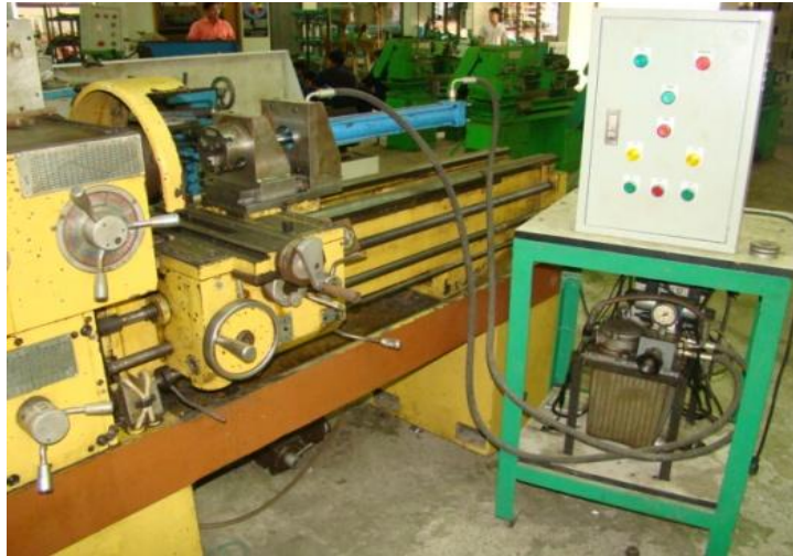
รูปที่ 3.4 เครื่องกลึงแนวอนาคิดตั้งระบบไฮดรอลิก
