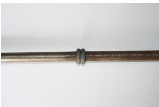
รูปที่ ก.6 ชิ้นงานที่ทำการเชื่อมด้วยความเสียดทานด้วยความเร็วรอบ 1,800 รอบ/นาทีที่เวลา 3 วินาที ความดัน 20 บาร์
