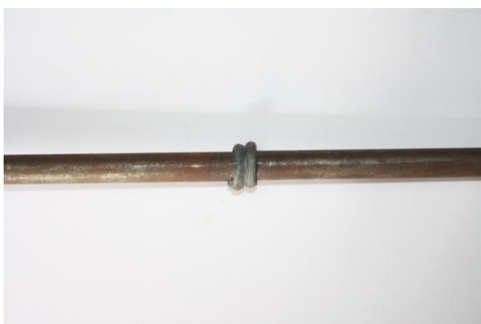
รูปที่ ก.5 ชิ้นงานที่ทำการเชื่อมด้วยความเสียดทานด้วยความเร็วรอบ 1,800 รอบ/นาที ที่เวลา 2 วินาที ความดัน 20 บาร์
