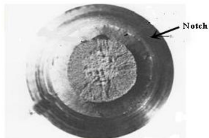
รูปที่ 3.21 บริเวณตำแหน่งการตรวจสอบการพังทลายของรอยเชื่อม
