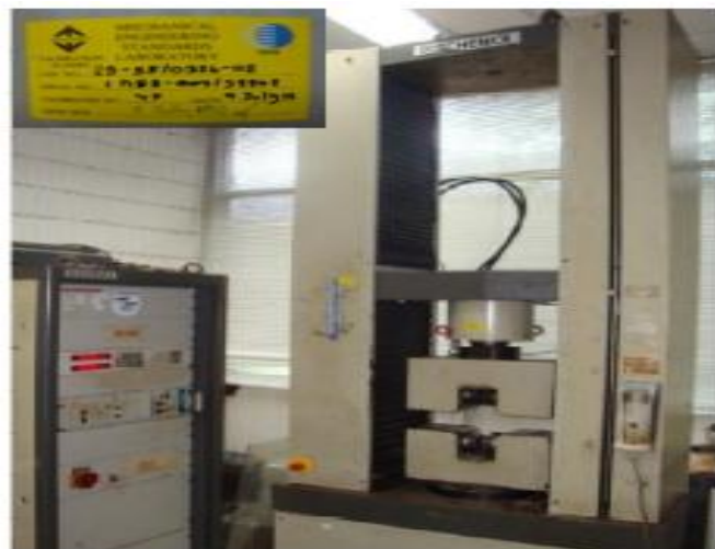
รูปที่ 3.11 เครื่องทดสอบแรงดึง (Tensile Test)
