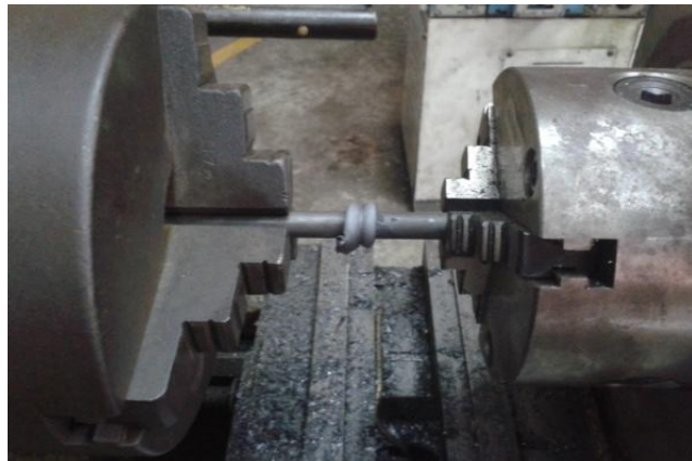
รูปที่ 3.9 การเชื่อมเสร็จสมบูรณ์หยุดเครื่องกลึงแบบทันที
