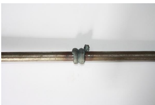
รูปที่ ก.8 ชิ้นงานที่ทำการเชื่อมด้วยความเสียดทานด้วยความเร็วรอบ 1,800 รอบ/นาทีที่เวลา 5 วินาที ความดัน 20 บาร์
