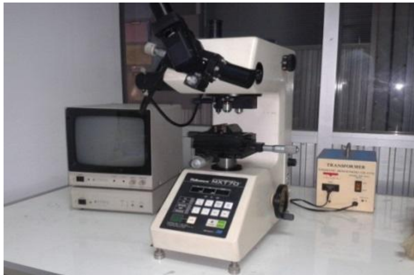
รูปที่ 3.13 เครื่อง Microhardness Test ตามมาตรฐาน ASTM E92
