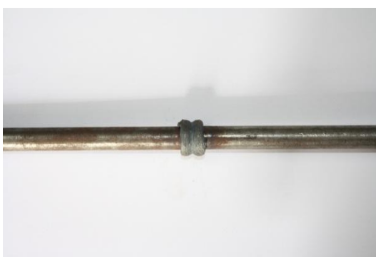
รูปที่ ก.11 ชิ้นงานที่ทำการเชื่อมด้วยความเสียดทานด้วยความเร็วรอบ 2,200 รอบ/นาทีที่เวลา 2 วินาที ความดัน 40 บาร์
