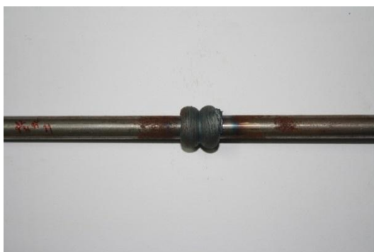
รูปที่ ก.3 ชิ้นงานที่ทำการเชื่อมด้วยความเสียดทานด้วยความเร็วรอบ 2,200 รอบ/นาที เวลา 2 วินาที ความดัน 20 บาร์
