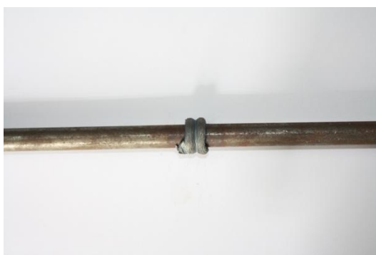
รูปที่ ก.10 ชิ้นงานที่ทำการเชื่อมด้วยความเสียดทานด้วยความเร็วรอบ 2,200 รอบ/นาทีที่เวลา 2 วินาที ความดัน 30 บาร์
