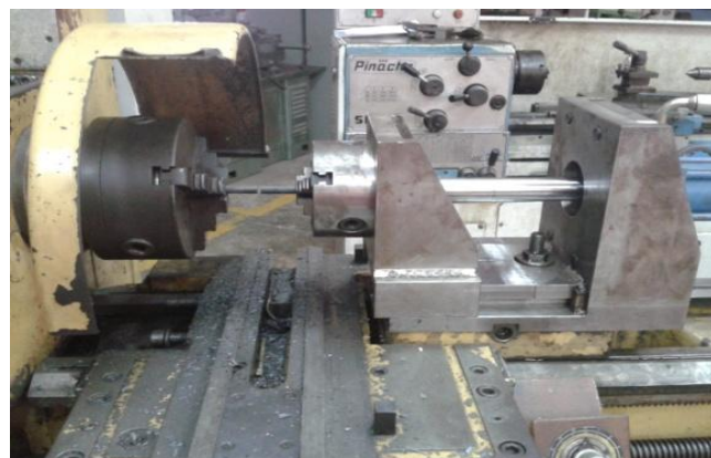
รูปที่ 3.8 การจับยึดชิ้นงานกับเครื่องกลึง
