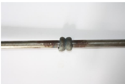
รูปที่ ก.12 ชิ้นงานที่ทำการเชื่อมด้วยความเสียดทานด้วยความเร็วรอบ 2,200 รอบ/นาทีที่เวลา 2 วินาที ความดัน 50 บาร์
