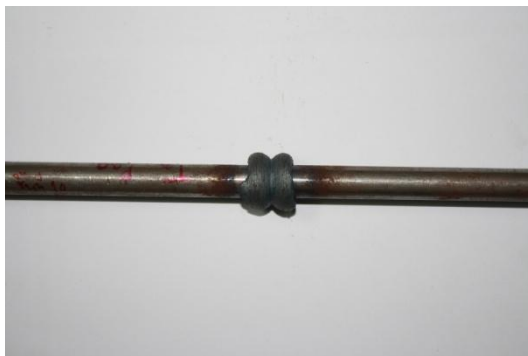
รูปที่ ก.2 ชิ้นงานที่ทำการเชื่อมด้วยความเสียดทานด้วยความเร็วรอบ 1,800 รอบ/นาที เวลา 2 วินาที ความดัน 20 บาร์
