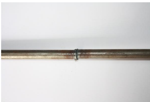
รูปที่ ก.4 ชิ้นงานที่ทำการเชื่อมด้วยความเสียดทานด้วยความเร็วรอบ 1,800 รอบ/นาที ที่เวลา 1 วินาที ความดัน 20 บาร์
