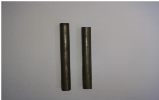
รูปที่ 3.1 เหล็กกล้า AISI 1045 ขนาดเส้นผ่าศูนย์กลาง 10 มิลลิเมตร ยาว 100 มิลลิเมตร
