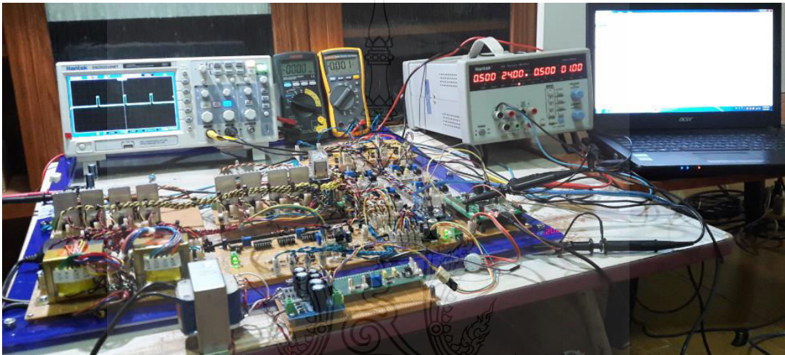
รูปที่ 4.1 การทดสอบการทำงานของวงจรคอนเวอร์เตอร์กระแสตรงแบบสองทิศทาง 4 เฟส
