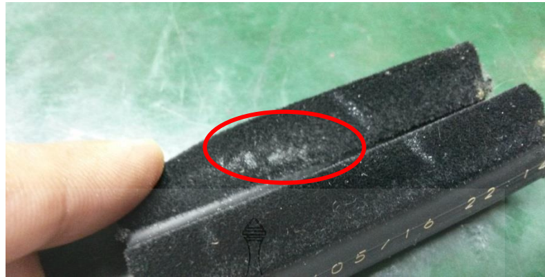
ภาพที่ 3.4 แสดงลักษณะของเสียบประเภทกำมะหยี่แหวงหลุดส่วนที่ปลุกชนกำมะหยี่เปิดหรือหลุดออก
