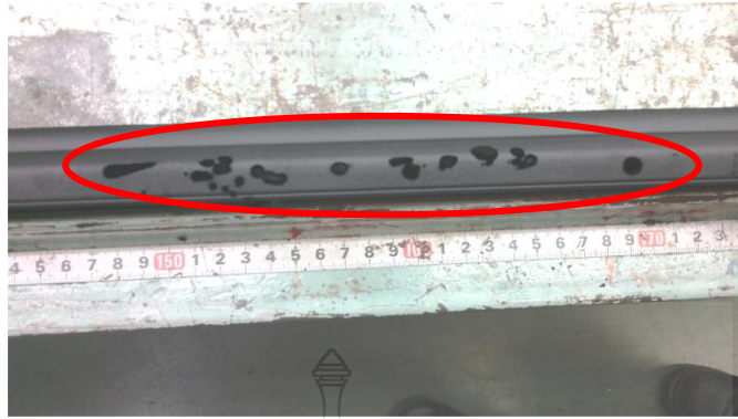
ภาพที่ 3.8 แสดงลักษณะของเสียบประเภทกำมะหยี่และฉนวนซึ่งมีการทากาวไม่ตรงจุดที่กำหนด
