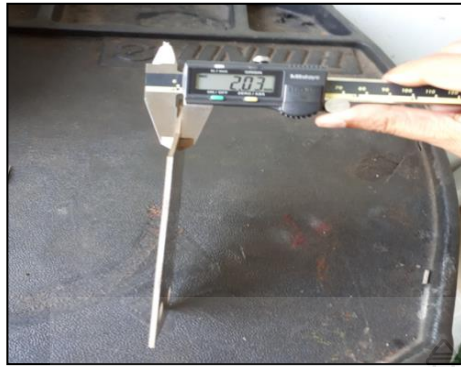
ภาพที่ 4.29 เปรียบเทียบความหนาของใบมีด Cutting ก่อน – หลัง การแก้ไข ครั้งที่ 1
