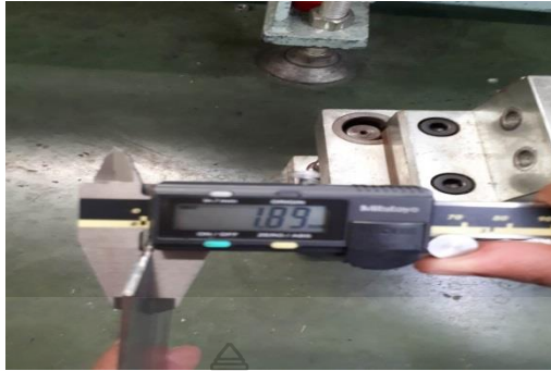
ภาพที่ 4.27 แสดงการวัดความหนาของใบมีด Cutting
