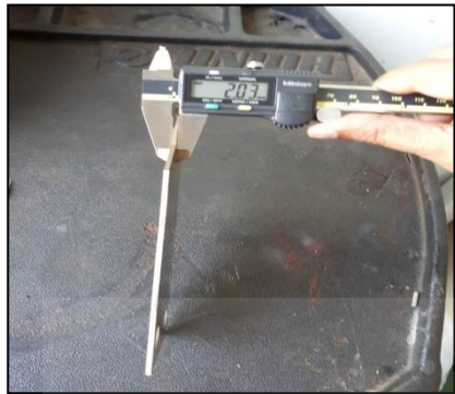
ภาพที่ 4.31 เปรียบเทียบความหนาของใบมีด Cutting ก่อน - หลัง การแก้ไข ครั้งที่ 2
