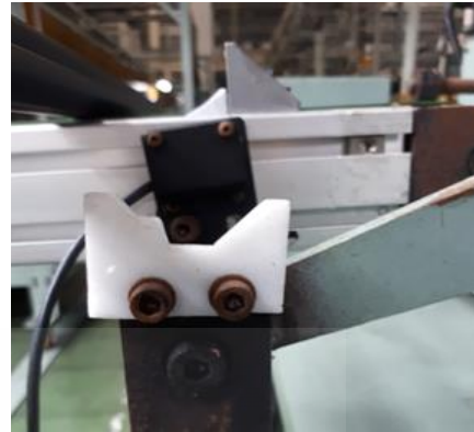
ภาพที่ 4.38 เปรียบเทียบชุดขายงาน Sensor ก่อน – หลัง การแก้ไข จากการปรับปรุงแก้ไขปัญหาชิ้นงานตกตู้จึงได้ผลการแก้ไขดังแสดงในภาพที่ 4.39
