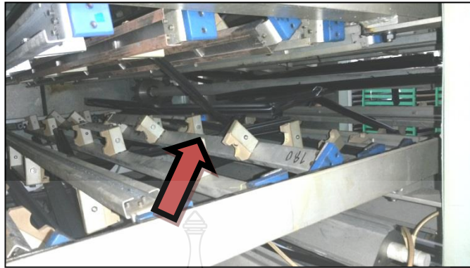
ภาพที่ 4.17 แสดงลักษณะของปัญหาชิ้นงานตกตู้
