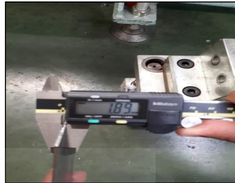
ภาพที่ 4.29 เปรียบเทียบความหนาของใบมีด Cutting ก่อน – หลัง การแก้ไข ครั้งที่ 1
