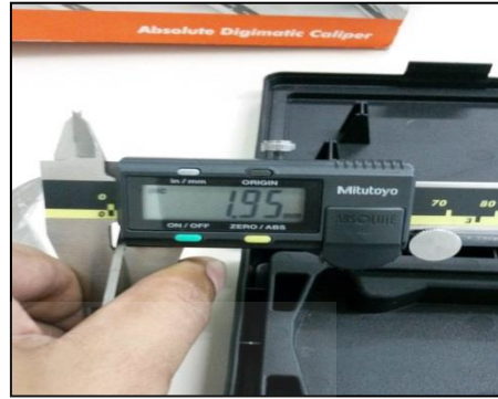
ภาพที่ 4.31 เปรียบเทียบความหนาของใบมีด Cutting ก่อน - หลัง การแก้ไข ครั้งที่ 2
