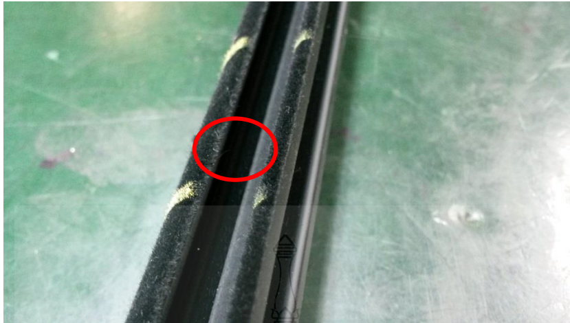
ภาพที่ 3.6 แสดงลักษณะของเสียบประเภทก้ามเหยี่ยวเป็นปุ่ม จะมีลักษณะนูนขึ้นมาบริเวณที่มีการปลุก ขนก้ามเหยี่ยว
