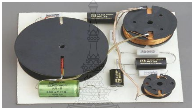
รูปที่ 2.19 วงจรครอสโอเวอร์แบบพาสซีฟ
