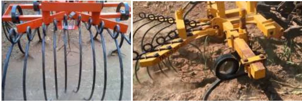
รูปที่ 2.26 ไถพรวนเหล็กสปริง [18]
