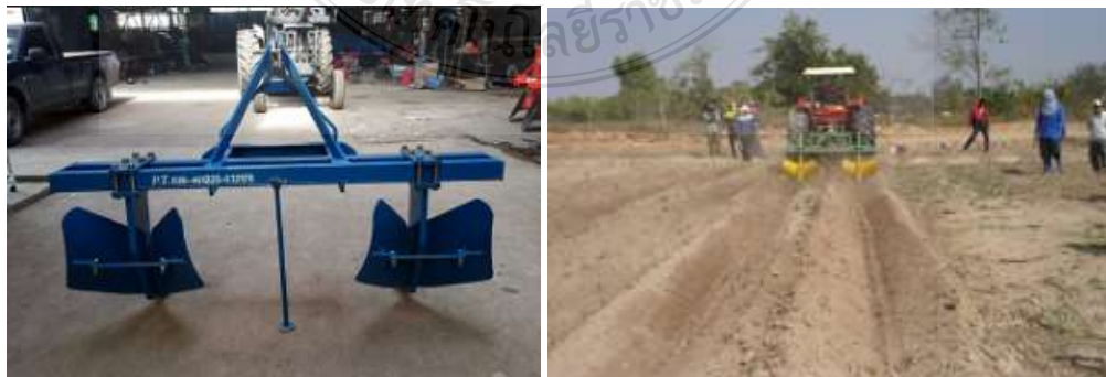
รูปที่ 2.28 เครื่องขร่งชนิดหัวหมู [18]
