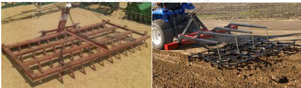
รูปที่ 2.25 ไถพรวนเหล็กแหลม [18]
