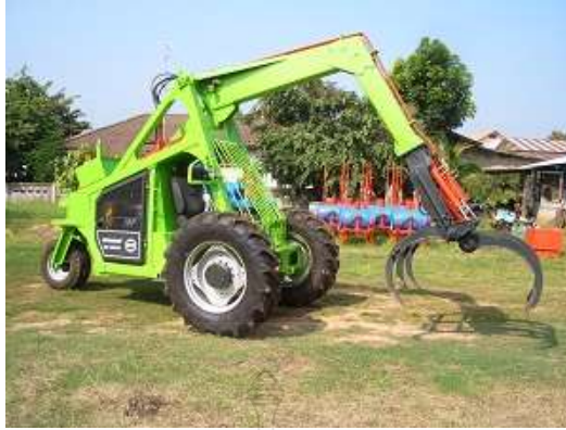
รูปที่ 2.45 รถคืบอ้อยแบบ 3 ล้อ(บูมเดี่ยว)
