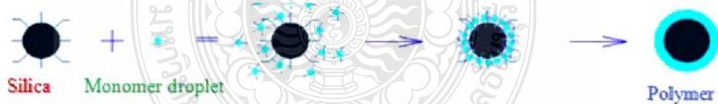
ภาพที่ 2.5 การเอนแคปซูลด้วยการสังเคราะห์แบบอินซิทู [25]
