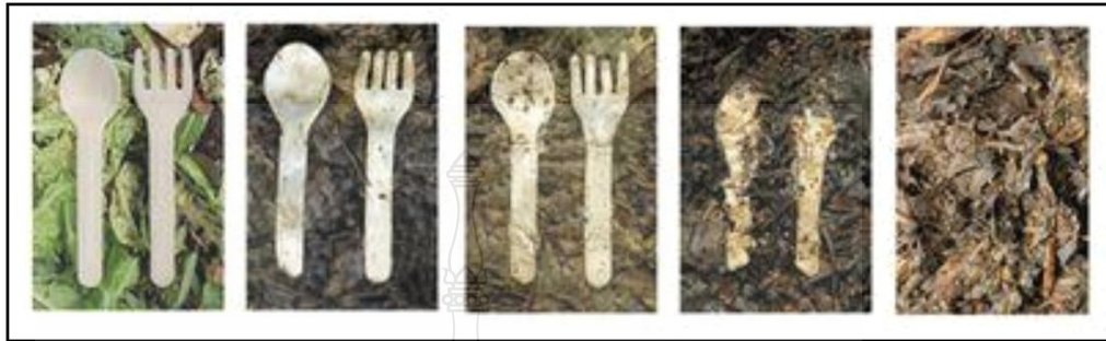
รูปที่ 2.5 แสดงการย่อยสลายของพอลิแลคติกแอซิด [8]
