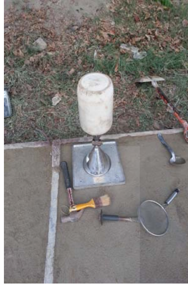
รูปที่ 3.8 ก่อนและหลังการบดอัด ทดสอบหาความหนาแน่นของดินในแปลงทดสอบ (Sand Cone Method)
