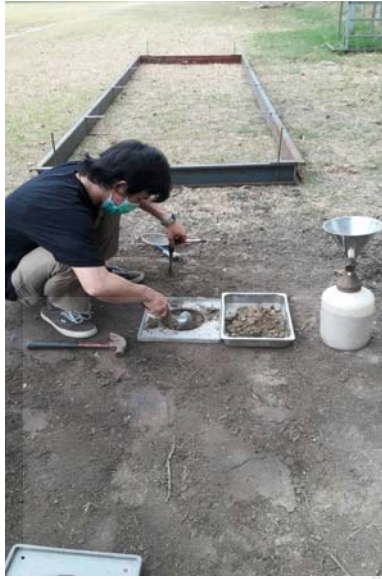
รูปที่ 3.8 ก่อนและหลังการบดอัด ทดสอบหาความหนาแน่นของดินในแปลงทดสอบ (Sand Cone Method)
