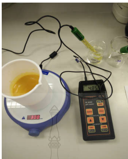
รูปที่ 3.2 ลักษณะของสารผสมหลังจากกวนให้เข้ากันและปรับพีเอชด้วยสารละลายกรด
