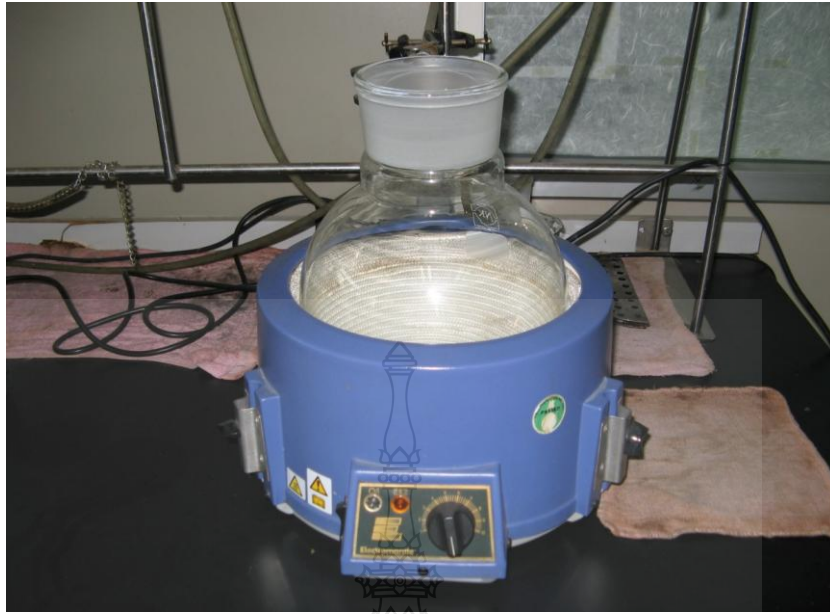
ภาพผนวกที่ 4 เครื่องกลั่นน้ำมันหอมระเหย วิธีการกลั่นด้วยน้ำและไอน้ำ (water and steam distillation)
