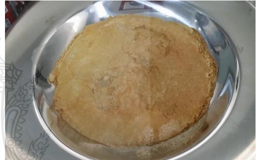
รูปที่ 3.3 แสดงการอบแห้งในตู้อบแห้งที่อุณหภูมิ 120 องศาเซลเซียส เป็นเวลา 5-10 ชั่วโมง
