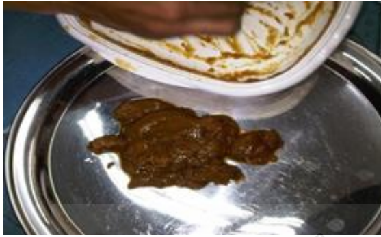
รูปที่ 3.2 แสดงการละลายรังไหมด้วยสารละลายโซเดียมไฮดรอกไซด์ จนละลายเป็นเนื้อเดียว และทำให้เป็นแป้งเปียก
