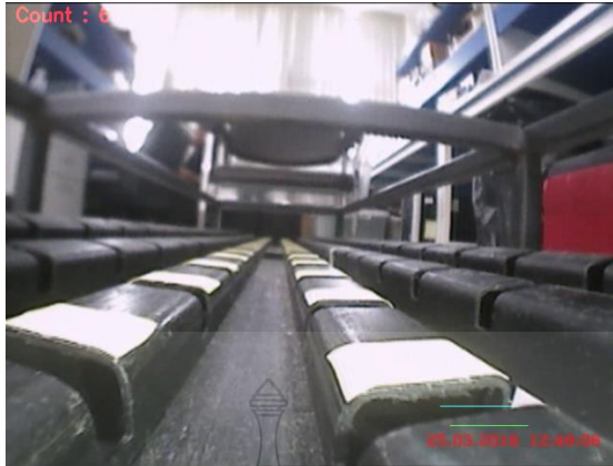
รูปที่ 3.15 ผลของการนับร่องระบายอากาศด้วยขั้นตอนวิธีที่นำเสนอ
