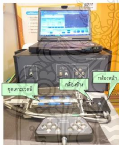
รูปที่ 2 หุ่นยนต์ตรวจสอบเครื่องกำเนิดไฟฟ้า
