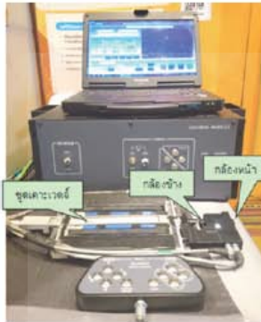
ภาพที่ 1 หุ่นยนต์ตรวจสอบเครื่องกำเนิดไฟฟ้าขนาดใหญ่
