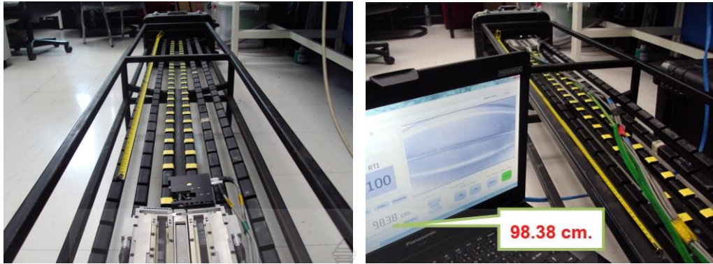
รูปที่ 3.1 ตัวอย่างการทดสอบความผิดพลาดของการระบุตำแหน่งโดยเอนโคเดอร์
