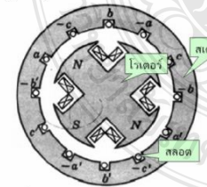
รูปที่ 3 ส่วนประกอบของเครื่องกำเนิดไฟฟ้า
