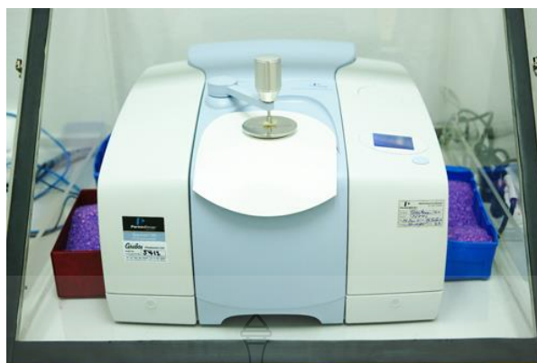
รูปที่ 3.6 เครื่องทดสอบตรวจสอบหมู่ฟังก์ชันเคมี Fourier Transform Infrared Spectrophotometer
