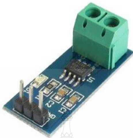
รูปที่ 3.11 วงจรส่วนตรวจจับกระแสไฟฟ้าออก
