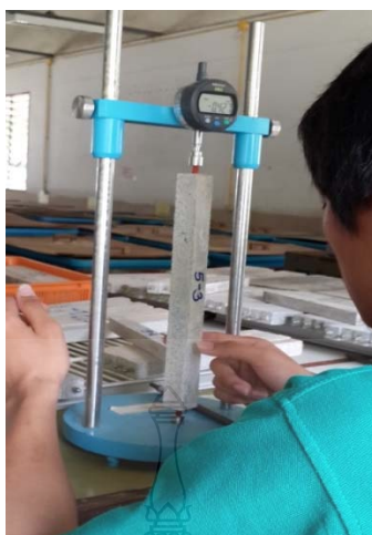
รูปที่ 3.9 การวัดค่าการขยายตัวของตัวอย่างมอร์ต้าร์ด้วยเครื่องวัดความยาว (length comparator)
