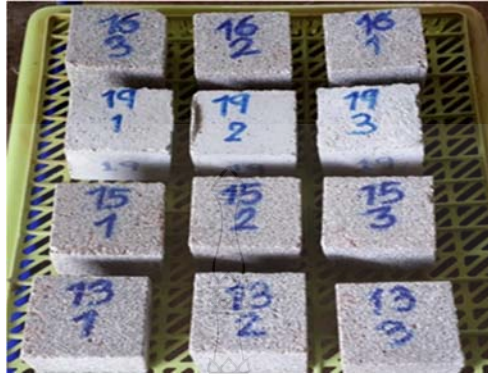
รูปที่ 3.10 ตัวอย่างมอร์ต้าร์ขนาด 5 x 5 x 5 ซม.
