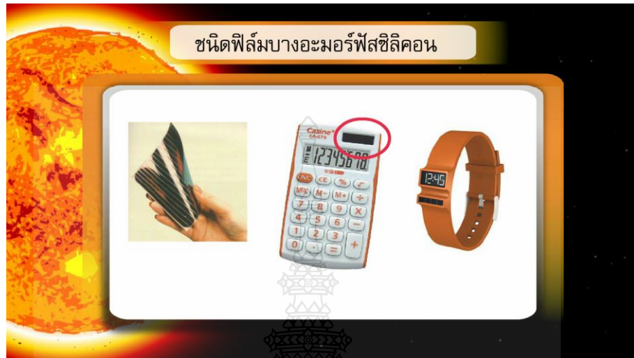
ภาพที่ ง.21 ตัวอย่างสื่อการสอน แผงเซลล์สุริยะที่ถูกใช้แต่ละอุปกรณ์
