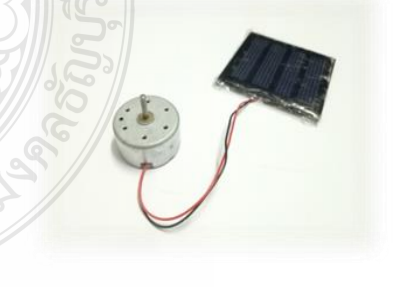
ภาพที่ ง.6 มอเตอร์ไฟฟ้า ต่อเข้ากับแผง เซลล์สุริยะ (โซลาร์เซลล์) แรงดัน 2 โวลต์ กระแส 100 มิลลิแอมป์
