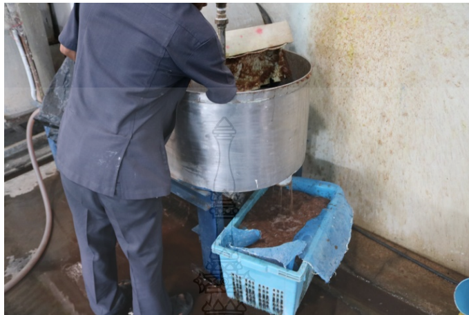
รูปที่ 3.6 การกรองน้ำออกให้เหลือแต่เชื้อเปลือกโสนหางไก่กับเชื้อปอสา
