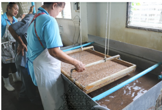
รูปที่ 3.8 การซ้อนเยื่อทำแผ่นกระดาษจากเปลือกโสนทางไถ่สะท้อนน้ำ
