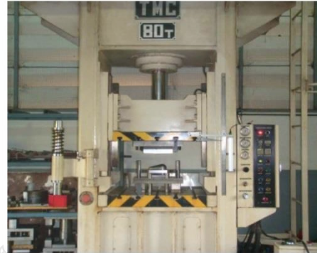
รูปที่ 4 การติดตั้งแม่พิมพ์บนเครื่องบีบไฮดรอลิก 80 ตัน
