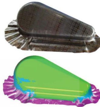
รูปที่ 10 เปรียบเทียบรูปร่างของชิ้นงานระหว่างการผลิตลงขั้นรูปกับการจำลองไฟไนต์เอลิเมนต์ โดยใช้ดอร์บีตที่มีความหนาผิว 0.152 Ra
