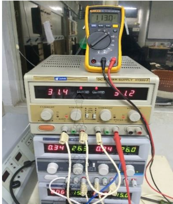
รูปที่ 3.36 แหล่งจ่ายแรงดันไฟฟ้ากระแสตรง
