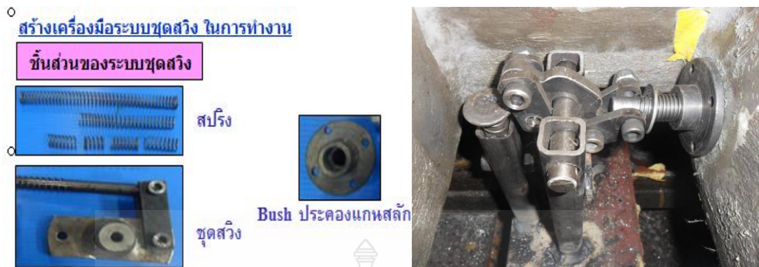
รูปที่ 4.29 ชุดอุปกรณ์สวิง และการติดตั้งอุปกรณ์ต้นแบบกับแม่พิมพ์
