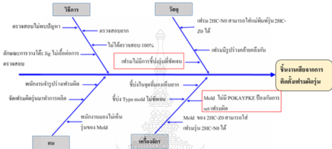
รูปที่ 4.9 การวิเคราะห์ปัญหาชิ้นงานเสียที่เกิดจากการติดตั้งเฟรมผิครุ่น
