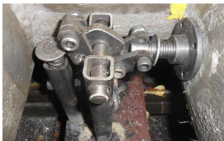
รูปที่ 17 การติดตั้งอุปกรณ์ต้นแบบกับแม่พิมพ์
