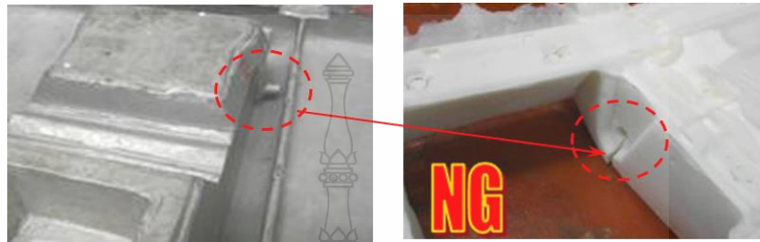
รูปที่ 4.14 ปัญหาของเสียที่เกิดจากการดึงชิ้นงานออกจากแม่พิมพ์
