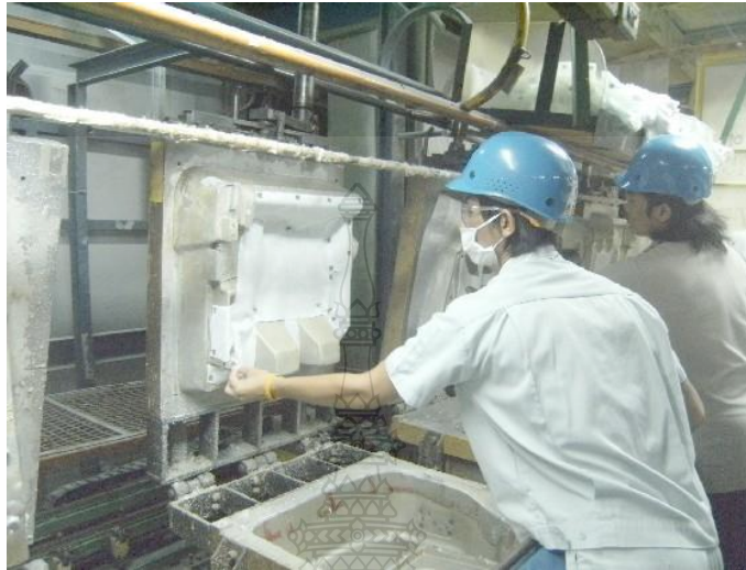
รูปที่ 3.6 ขั้นตอนการ Set ผ้า หรือ Spun Bond
