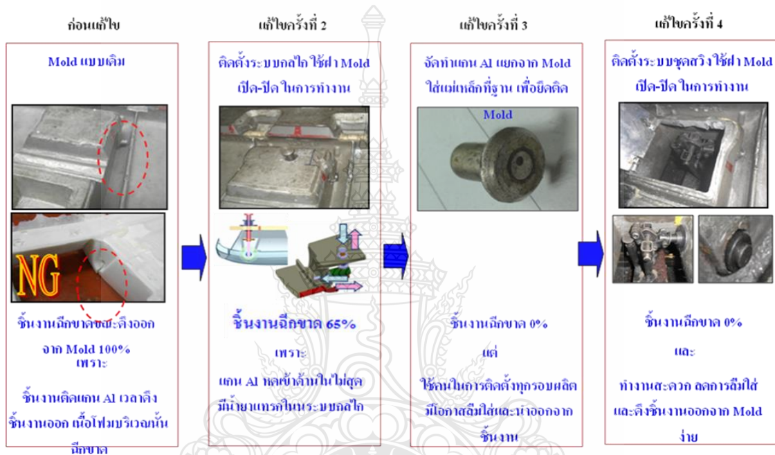
รูปที่ 5.1 วิวัฒนาการแก้ไขปัญหาลำดับขั้นตอนการดึงชิ้นงานออกจากแม่พิมพ์
