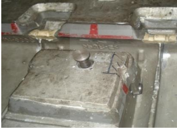
รูปที่ 12 ลักษณะการไหลออกมาของแกนอะลูมิเนียม
