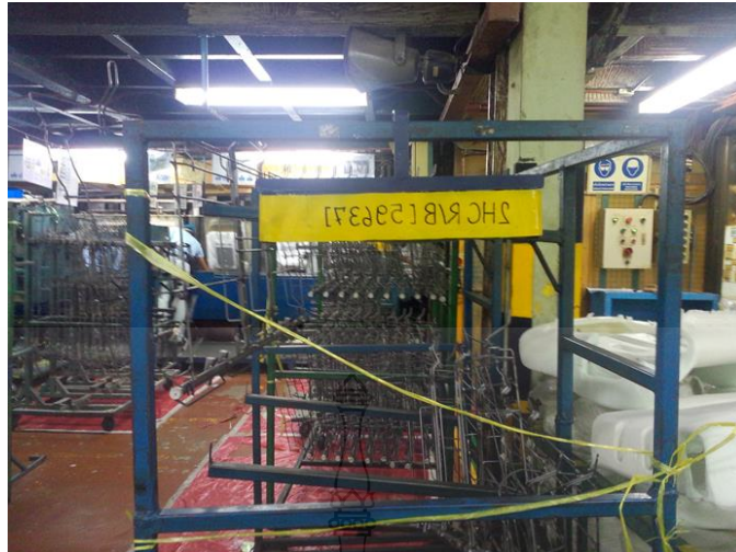
รูปที่ 4.32 อุปกรณ์แขวนเฟรมที่ไม่มีป้ายบังซี
