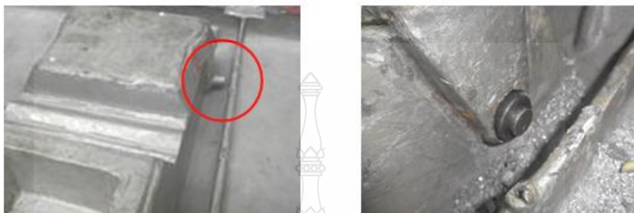
รูปที่ 4.4 ลักษณะแกนอลูมิเนียมที่ไหลอยู่ในแม่พิมพ์
