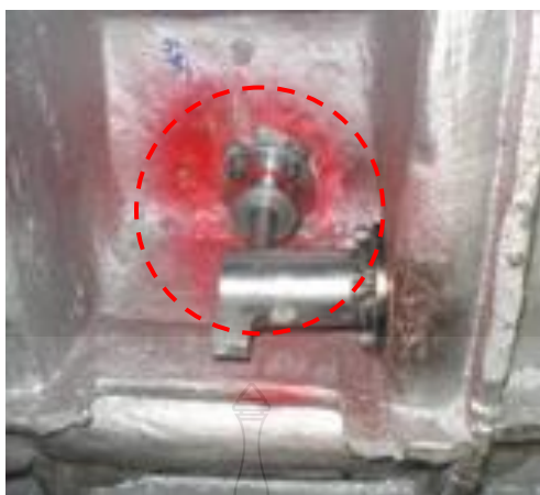
รูปที่ 4.21 การติดตั้งอุปกรณ์ต้นแบบกับแม่พิมพ์
