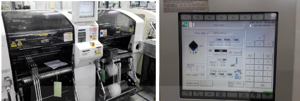
รูปที่ 3.7 เครื่องวางอุปกรณ์อิเล็กทรอนิกส์ลงบนแผ่นพีซีบี (Pick and Place)
