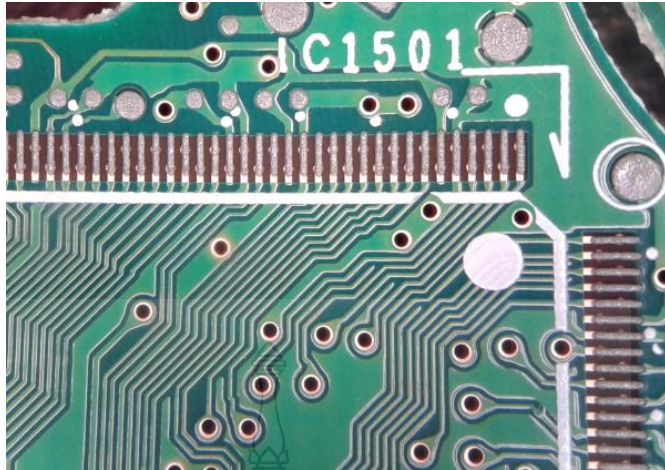
รูปที่ 3.4 ลักษณะครีมนโลหะบัดกรีที่พิมพ์ออกมาบริเวณไอซี 1501 บนพีซีบีด้านบน
