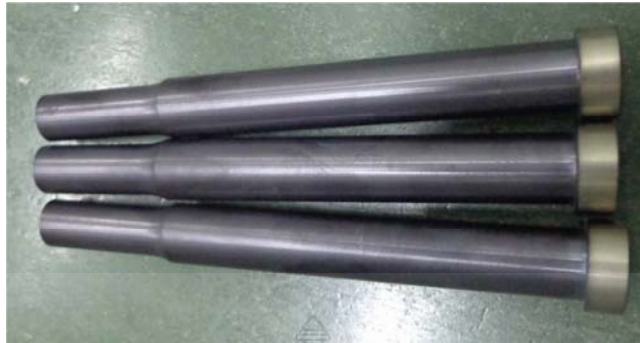
รูปที่ 3.9 พันซ์ที่ใช้สารเคลือบ TiAlN (PVD)
