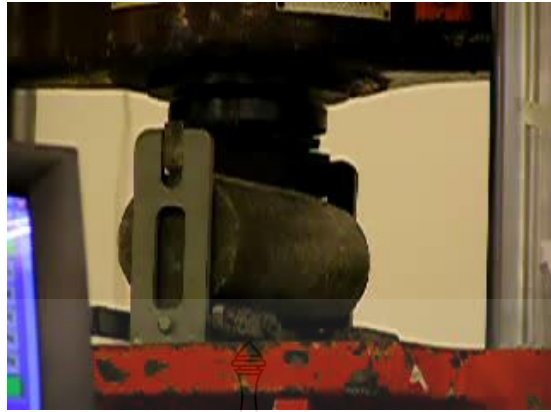
รูปที่ 2.9 การทดสอบแรงดึงของคอนกรีตโดยวิธีผ่าซีก [24] (ต่อ)
