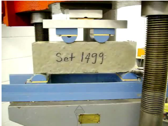
รูปที่ 2.12 การทดสอบการรับแรงดึงของคานคอนกรีตโดยวิธีตัด [24] (ต่อ)
