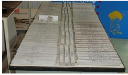
รูปที่ 3.18 ชิ้นตัวอย่างเพสต์ที่บ่มในหม้อต้ม Autoclave
