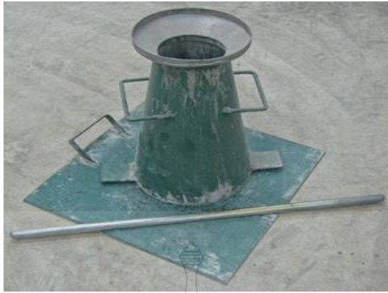
รูปที่ 2.2 กรวย เหล็กกระทุ้ง และถาดรอง สำหรับทดสอบค่าการยุบตัว
