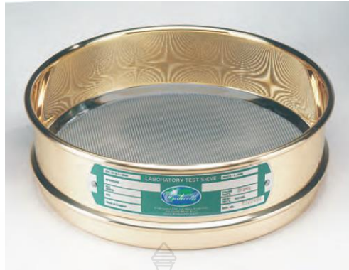
รูปที่ 3.7 ตะแกรงร่อนมาตรฐานขนาดเบอร์ 4 [27]
