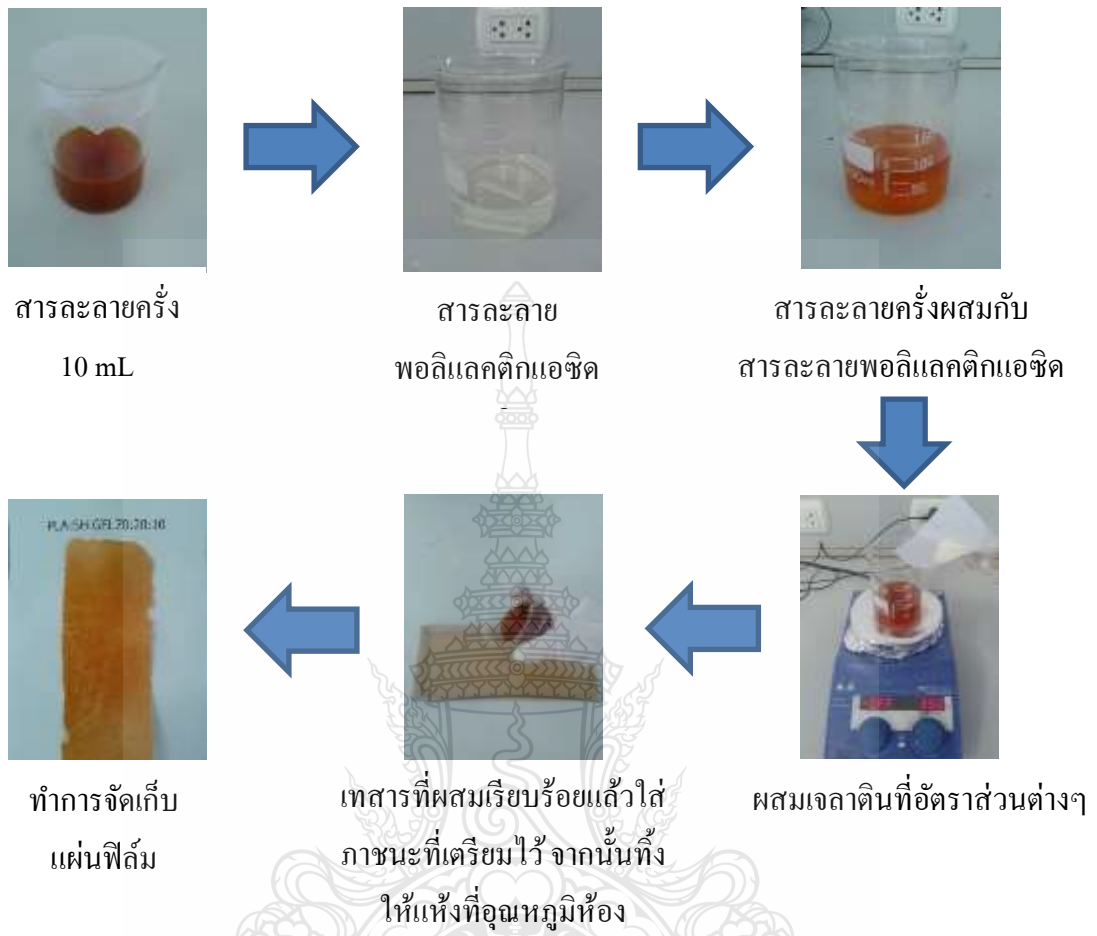
รูปที่ 3.1 วิธีการเตรียมฟิล์มพอลิเมอร์ผสมระหว่างพอลิแลคติกแอซิด เจลาตินและเซลแลคด้วยวิธี Solvent casting
