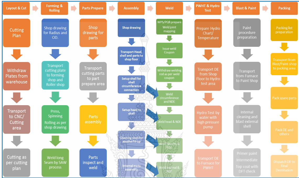
ภาพที่ 4.3 แสดง Top-Down ของกระบวนการผลิตถังแรงดันแบบดีเอเรเตอร์
