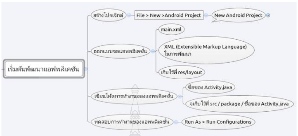
ภาพที่ 2.3 แสดงขั้นตอนของการพัฒนาแอปพลิเคชันแอนดรอยด์
