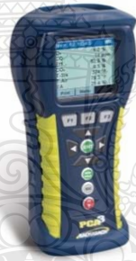
ภาพที่ 2.2 เครื่องวิเคราะห์การเผาไหม้แบบมือถือ (PCA 3)
