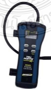
ภาพที่ 2.4 เครื่องตรวจจับการรั่วไหลของสารทำความเย็นแบบพกพาที่ใช้เซ็นเซอร์อินฟราเรด (Tru Pointe IR)
