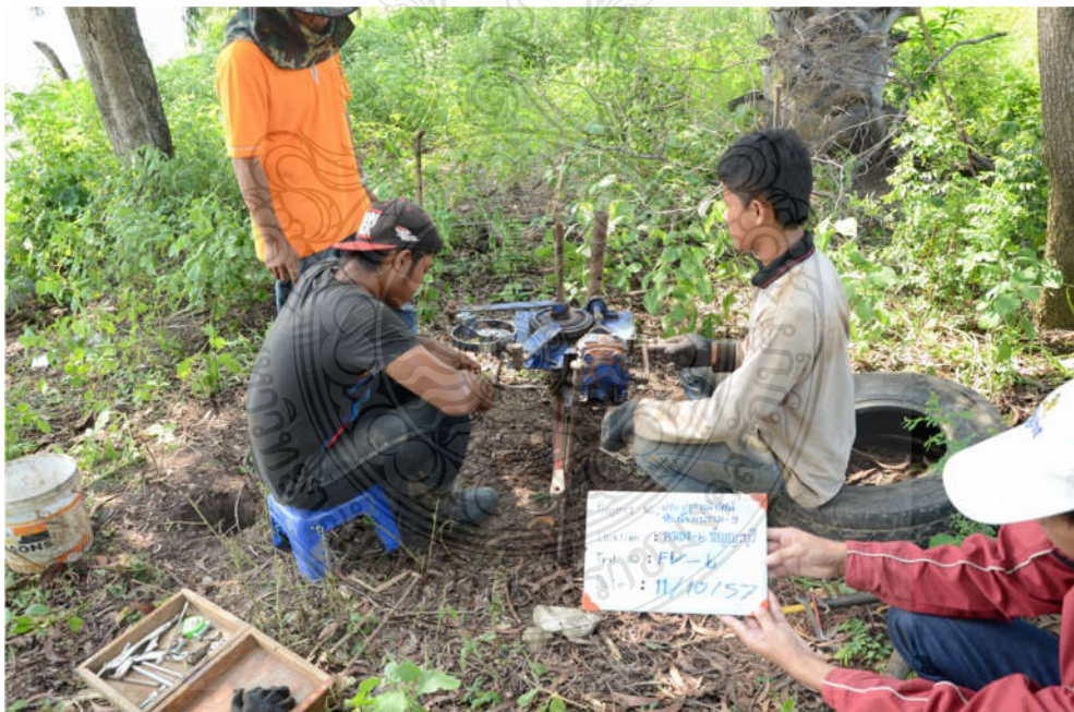
รูปที่ 3.10 การทดสอบกำลังรับแรงเฉือนในสนามของดินในสนามด้วย Field Vane Shear Test
