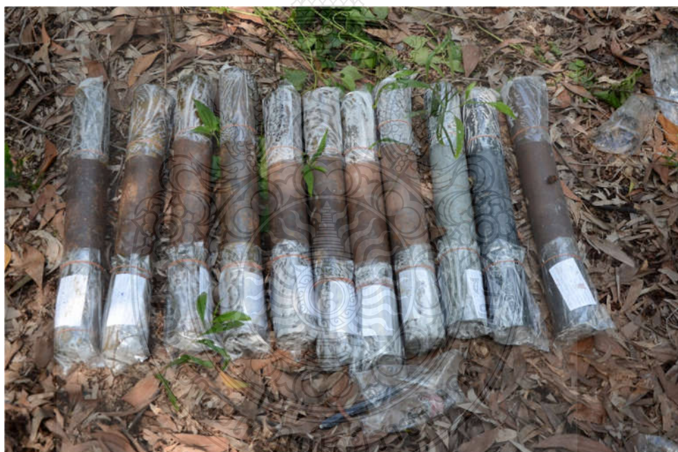
รูปที่ 3.6 การเก็บด้วยกระบอกบาง (Shelby Tube)
