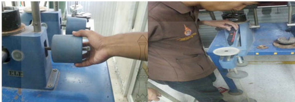
รูปที่ 3.18 หมุนปรับลูกตุ้มถ่วงน้ำหนัก (Counterbalance Weight)
