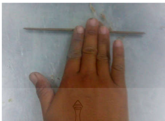
รูปที่ 3.15 แสดงการทดสอบ Plastic Limit
