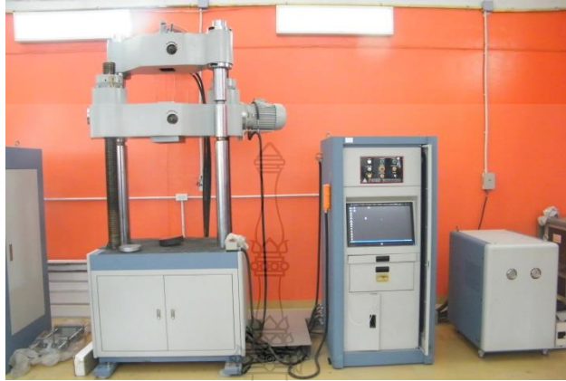
รูปที่ 3.8 เครื่องทดสอบ Universal Testing Machine ขนาด 100 ตัน
