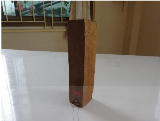
รูปที่ 3.2 ไม้สี่เหลี่ยม ขนาด 50x50x200 มิลลิเมตร
