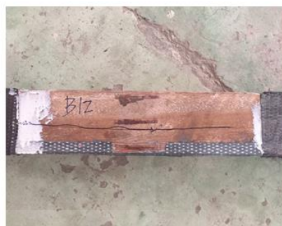
(ข) การวิบัติของคานไม้ B12
