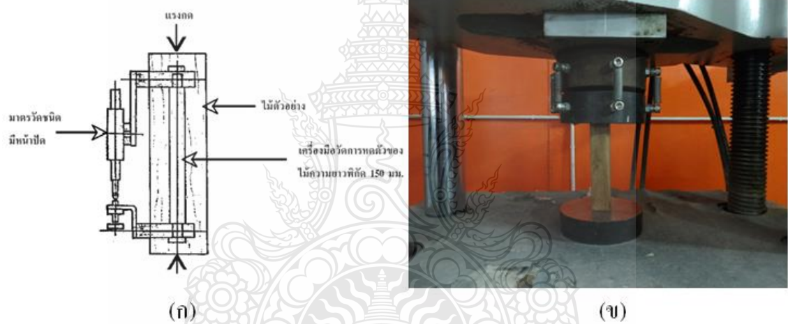
รูปที่ 3.13 การทดสอบหาค่าแรงอัดในแนวนานเส้นของไม้
