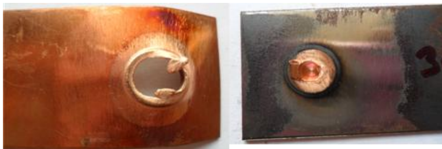
รูปที่ 38 แสดงลักษณะรูปแบบการพังทลายของชิ้นงานทดสอบที่ความเร็วรอบตัวถวน 3500 รอบ/นาที เวลาในการรูดแซ่ 4 วินาที และอัตราป้อน 4 มม./นาที
