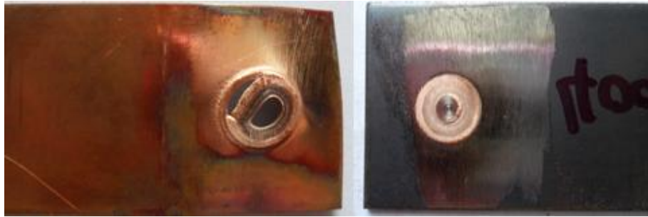
รูปที่ 63 แสดงลักษณะรูปแบบการพังทลายของชิ้นงานทดสอบที่ความเร็วรอบตัวกวน 4000 รอบ/นาที เวลาในการกัดแซ่ 8 วินาที และอัตราป้อน 6 มม./นาที
