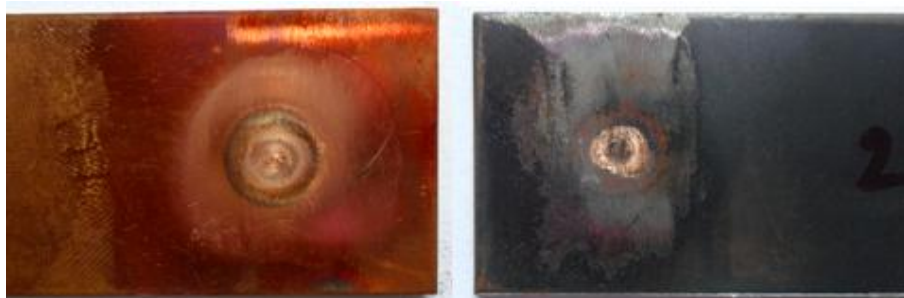
รูปที่ 9 แสดงลักษณะรูปแบบการพังทลายของชิ้นงานทดสอบที่ความเร็วรอบตัวกวน 2500 รอบ/นาที เวลาในการรูดแซ่ 6 วินาที และอัตราป้อน 2 มม./นาที
