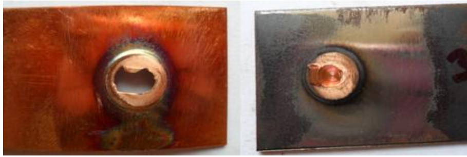
รูปที่ 30 แสดงลักษณะรูปแบบการพังทลายของชิ้นงานทดสอบที่ความเร็วรอบตัวกวน 3000 รอบ/นาที เวลาในการกัดแซ่ 8 วินาที และอัตราป้อน 4 มม./นาที
