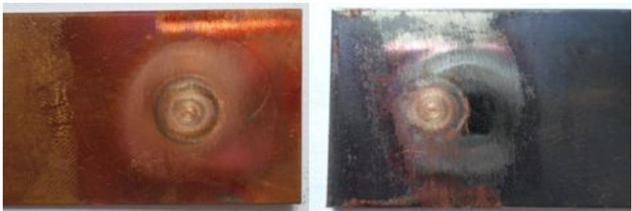
รูปที่ 5 แสดงลักษณะรูปแบบการพังทลายของชิ้นงานทดสอบที่ความเร็วรอบตัวกวน 2500 รอบ/นาที เวลาในการกัดแซ่ 4 วินาที และอัตราป้อน 2 มม./นาที
