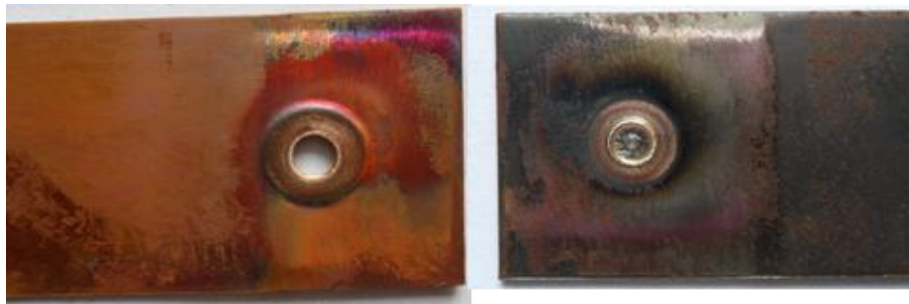
รูปที่ 16 แสดงลักษณะรูปแบบการพังทลายของชิ้นงานทดสอบที่ความเร็วรอบตัวกวน 2500 รอบ/นาที เวลาในการรูดแซ่ 8 วินาที และอัตราป้อน 8 มม./นาที
