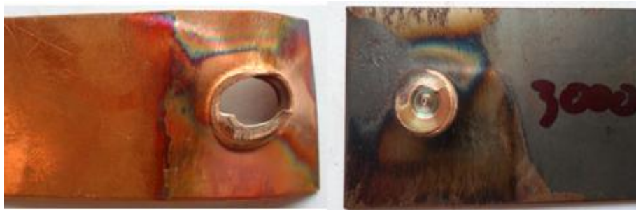
รูปที่ 23 แสดงลักษณะรูปแบบการพังทลายของชิ้นงานทดสอบที่ความเร็วรอบตัวถวน 3000 รอบ/นาที เวลาในการทดสอบ 4 วินาที และอัตราป้อน 6 มม./นาที
