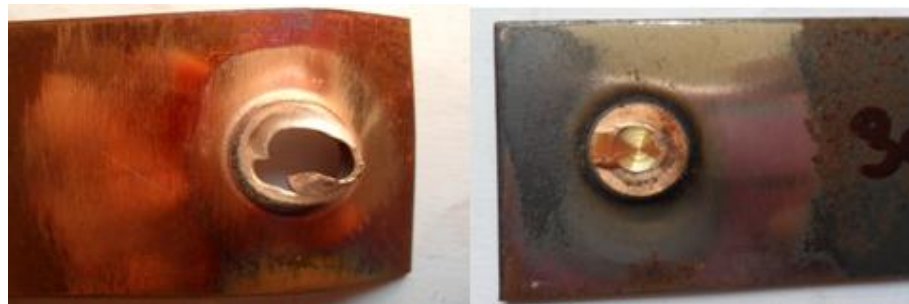
รูปที่ 37 แสดงลักษณะรูปแบบการพังทลายของชิ้นงานทดสอบที่ความเร็วรอบตัวถวน 3500 รอบ/นาที เวลาในการรูดแซ่ 4 วินาที และอัตราป้อน 2 มม./นาที
