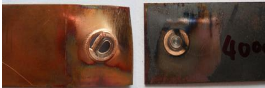
รูปที่ 55 แสดงลักษณะรูปแบบการพังทลายของชิ้นงานทดสอบที่ความเร็วรอบตัวถวน 4000 รอบ/นาที เวลาในการรูดแซ่ 4 วินาที และอัตราป้อน 6 มม./นาที
