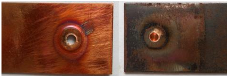
รูปที่ 8 แสดงลักษณะรูปแบบการพังทลายของชิ้นงานทดสอบที่ความเร็วรอบตัวกวน 2500 รอบ/นาที เวลาในการกัดแช่ 4 วินาที และอัตราป้อน 8 มม./นาที
