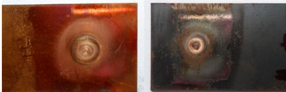
รูปที่ 4 แสดงลักษณะรูปแบบการพังทลายของชิ้นงานทดสอบที่ความเร็วรอบตัวกวน 2500 รอบ/นาที เวลาในการกัดแซ่ 2 วินาที และอัตราป้อน 8 มม./นาที
