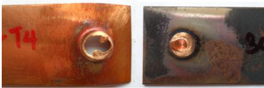
รูปที่ 24 แสดงลักษณะรูปแบบการพังทลายของชิ้นงานทดสอบที่ความเร็วรอบตัวถวน 3000 รอบ/นาที เวลาในการกัดแซ่ 4 วินาที และอัตราป้อน 8 มม./นาที
