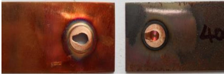
รูปที่ 36 แสดงลักษณะรูปแบบการพังทลายของชิ้นงานทดสอบที่ความเร็วรอบตัวถวน 3500 รอบ/นาที เวลาในการรูดแซ่ 2 วินาที และอัตราป้อน 8 มม./นาที
