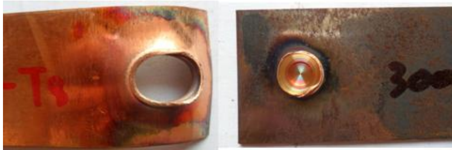
รูปที่ 19 แสดงลักษณะรูปแบบการพังทลายของชิ้นงานทดสอบที่ความเร็วรอบตัวกวน 3000 รอบ/นาที เวลาในการรูดแซ่ 2 วินาที และอัตราป้อน 6 มม./นาที
