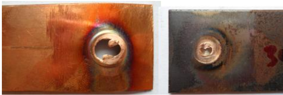
รูปที่ 42 แสดงลักษณะรูปแบบการพังทลายของชิ้นงานทดสอบที่ความเร็วรอบตัวถวน 3500 รอบ/นาที เวลาในการรูดแซ่ 6 วินาที และอัตราป้อน 4 มม./นาที
