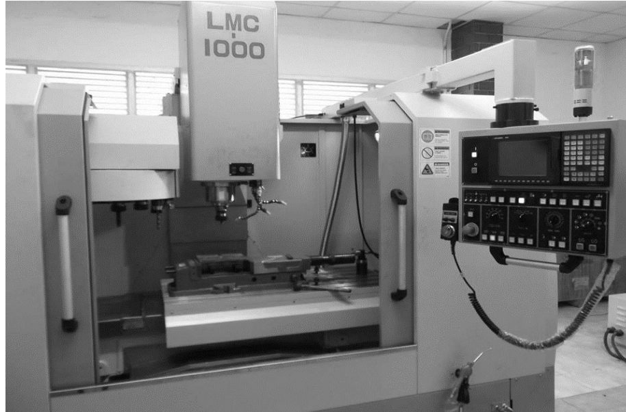
รูปที่ 3.5 เครื่องกัดที่ประยุกต์ใช้งานสำหรับกระบวนการเชื่อมด้วยแรงเสียดทานแบบจุด (CNC Milling)
