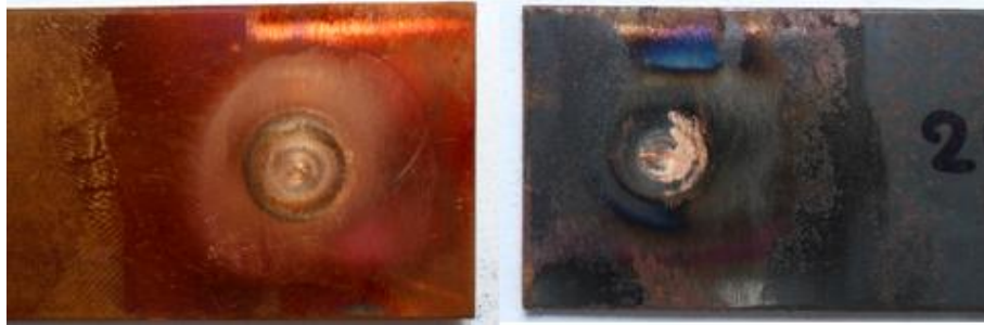
รูปที่ 12 แสดงลักษณะรูปแบบการพังทลายของชิ้นงานทดสอบที่ความเร็วรอบตัวกวน 2500 รอบ/นาที เวลาในการกัดแซ่ 6 วินาที และอัตราป้อน 8 มม./นาที
