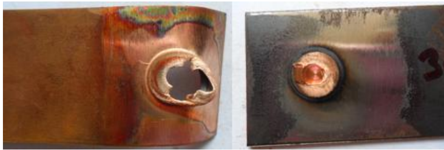
รูปที่ 45 แสดงลักษณะรูปแบบการพังทลายของชิ้นงานทดสอบที่ความเร็วรอบตัวกวน 3500 รอบ/นาที เวลาในการรูดแซ่ 8 วินาที และอัตราป้อน 2 มม./นาที
