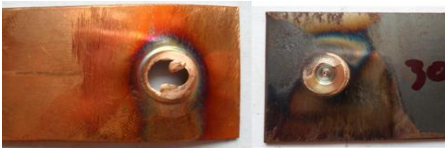
รูปที่ 28 แสดงลักษณะรูปแบบการพังทลายของชิ้นงานทดสอบที่ความเร็วรอบตัวกวน 3000 รอบ/นาที เวลาในการรูดแซ่ 6 วินาที และอัตราป้อน 8 มม./นาที
