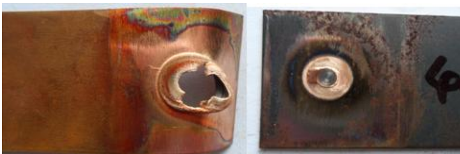
รูปที่ 59 แสดงลักษณะรูปแบบการพังทลายของชิ้นงานทดสอบที่ความเร็วรอบตัวถวน 4000 รอบ/นาที เวลาในการกัดแซ่ 6 วินาที และอัตราป้อน 6 มม./นาที
