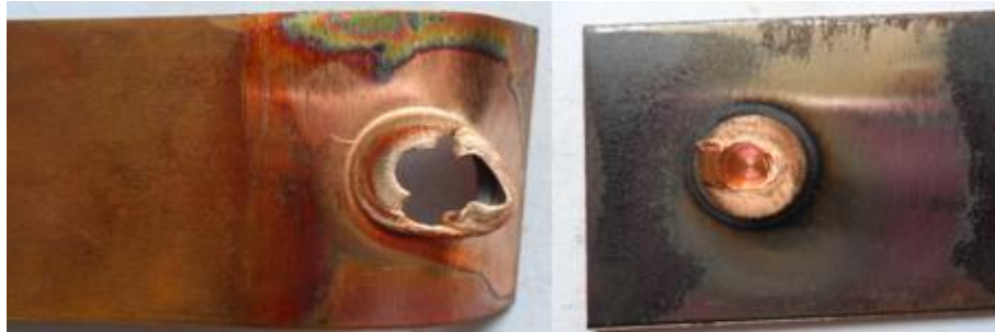
รูปที่ 61 แสดงลักษณะรูปแบบการพังทลายของชิ้นงานทดสอบที่ความเร็วรอบตัวกวน 4000 รอบ/นาที เวลาในการรูดแซ่ 8 วินาที และอัตราป้อน 2 มม./นาที
