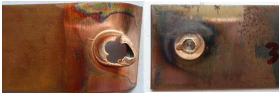
รูปที่ 47 แสดงลักษณะรูปแบบการพังทลายของชิ้นงานทดสอบที่ความเร็วรอบตัวกวน 3500 รอบ/นาที เวลาในการรูดแซ่ 8 วินาที และอัตราป้อน 6 มม./นาที
