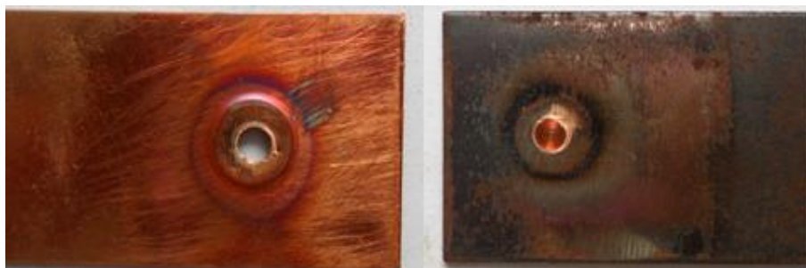
รูปที่ 10 แสดงลักษณะรูปแบบการพังทลายของชิ้นงานทดสอบที่ความเร็วรอบตัวกวน 2500 รอบ/นาที เวลาในการรูดแซ่ 6 วินาที และอัตราป้อน 4 มม./นาที
