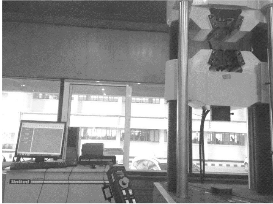
รูปที่ 3.9 เครื่องทดสอบแรงดึง (Universal Testing Machine)
