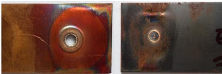
รูปที่ 17 แสดงลักษณะรูปแบบการพังทลายของชิ้นงานทดสอบที่ความเร็วรอบตัวกวน 3000 รอบ/นาที เวลาในการรูดแซ่ 2 วินาที และอัตราป้อน 2 มม./นาที
