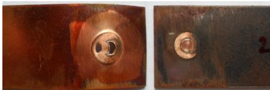
รูปที่ 7 แสดงลักษณะรูปแบบการพังทลายของชิ้นงานทดสอบที่ความเร็วรอบตัวกวน 2500 รอบ/นาที เวลาในการกัดแช่ 4 วินาที และอัตราป้อน 6 มม./นาที
