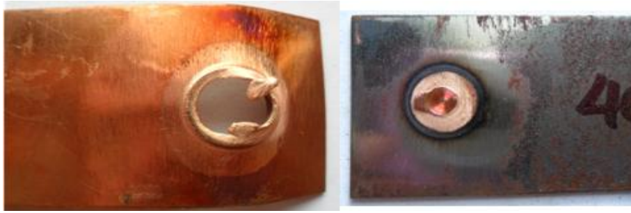
รูปที่ 60 แสดงลักษณะรูปแบบการพังทลายของชิ้นงานทดสอบที่ความเร็วรอบตัวกวน 4000 รอบ/นาที เวลาในการรูดแซ่ 6 วินาที และอัตราป้อน 8 มม./นาที
