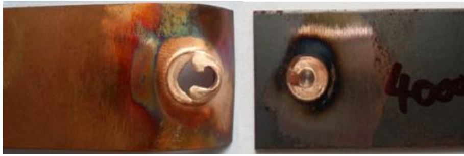
รูปที่ 51 แสดงลักษณะรูปแบบการพังทลายของชิ้นงานทดสอบที่ความเร็วรอบตัวกวน 4000 รอบ/นาที เวลาในการรูดแซ่ 2 วินาที และอัตราป้อน 6 มม./นาที
