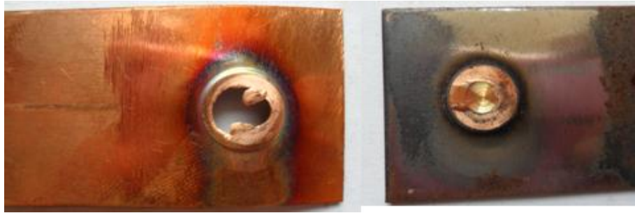
รูปที่ 54 แสดงลักษณะรูปแบบการพังทลายของชิ้นงานทดสอบที่ความเร็วรอบตัวถวน 4000 รอบ/นาที เวลาในการรูดแซ่ 4 วินาที และอัตราป้อน 4 มม./นาที
