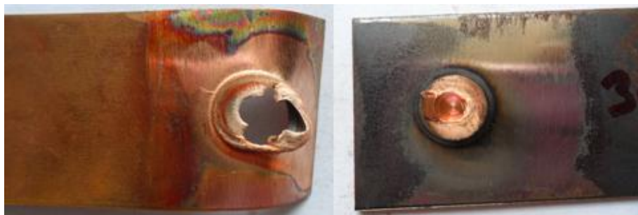
รูปที่ 53 แสดงลักษณะรูปแบบการพังทลายของชิ้นงานทดสอบที่ความเร็วรอบตัวกวน 4000 รอบ/นาที เวลาในการรูดแซ่ 4 วินาที และอัตราป้อน 2 มม./นาที
