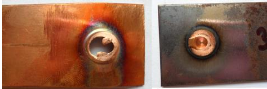
รูปที่ 39 แสดงลักษณะรูปแบบการพังทลายของชิ้นงานทดสอบที่ความเร็วรอบตัวถวน 3500 รอบ/นาที เวลาในการรูดแซ่ 4 วินาที และอัตราป้อน 6 มม./นาที
