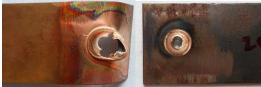
รูปที่ 6 แสดงลักษณะรูปแบบการพังทลายของชิ้นงานทดสอบที่ความเร็วรอบตัวกวน 2500 รอบ/นาที เวลาในการกัดแช่ 4 วินาที และอัตราป้อน 4 มม./นาที
