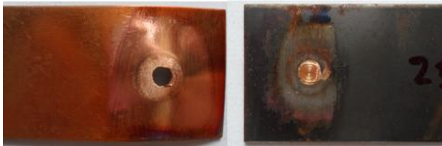
รูปที่ 25 แสดงลักษณะรูปแบบการพังทลายของชิ้นงานทดสอบที่ความเร็วรอบตัวถวน 3000 รอบ/นาที เวลาในการกัดแซ่ 6 วินาที และอัตราป้อน 2 มม./นาที
