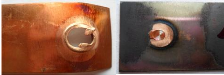
รูปที่ 15 แสดงลักษณะรูปแบบการพังทลายของชิ้นงานทดสอบที่ความเร็วรอบตัวกวน 2500 รอบ/นาที เวลาในการรูดแซ่ 8 วินาที และอัตราป้อน 6 มม./นาที
