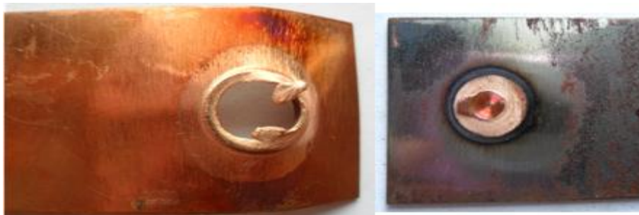
รูปที่ 46 แสดงลักษณะรูปแบบการพังทลายของชิ้นงานทดสอบที่ความเร็วรอบตัวกวน 3500 รอบ/นาที เวลาในการรูดแซ่ 8 วินาที และอัตราป้อน 4 มม./นาที
