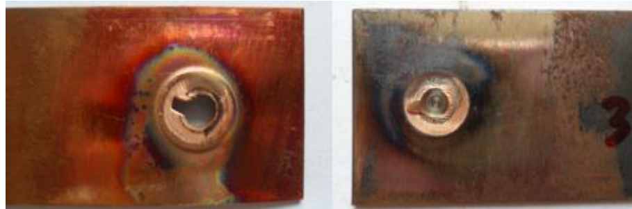
รูปที่ 40 แสดงลักษณะรูปแบบการพังทลายของชิ้นงานทดสอบที่ความเร็วรอบตัวถวน 3500 รอบ/นาที เวลาในการรูดแซ่ 4 วินาที และอัตราป้อน 8 มม./นาที
