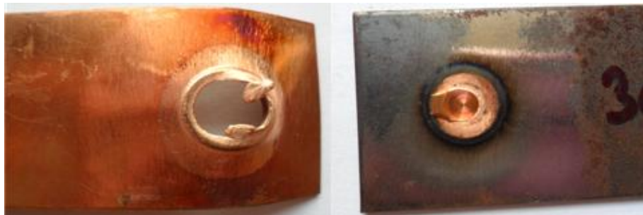
รูปที่ 43 แสดงลักษณะรูปแบบการพังทลายของชิ้นงานทดสอบที่ความเร็วรอบตัวถวน 3500 รอบ/นาที เวลาในการรูดแซ่ 6 วินาที และอัตราป้อน 6 มม./นาที
