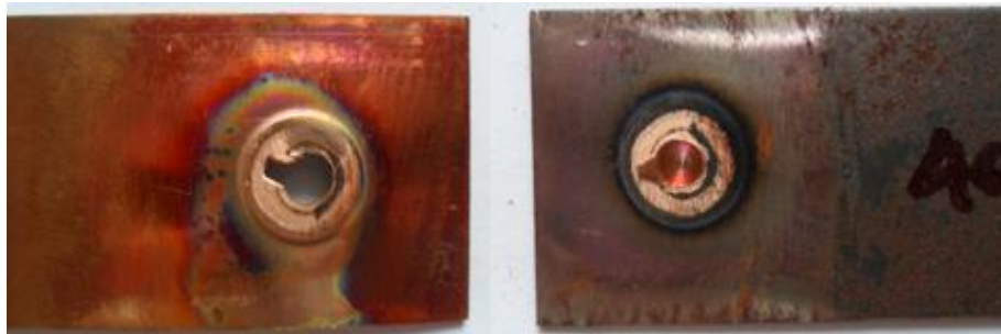
รูปที่ 49 แสดงลักษณะรูปแบบการพังทลายของชิ้นงานทดสอบที่ความเร็วรอบตัวกวน 4000 รอบ/นาที เวลาในการกัดแซ่ 2 วินาที และอัตราป้อน 2 มม./นาที
