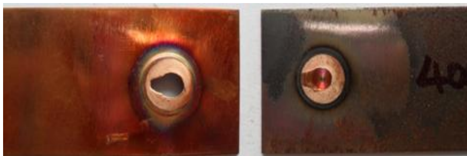
รูปที่ 50 แสดงลักษณะรูปแบบการพังทลายของชิ้นงานทดสอบที่ความเร็วรอบตัวกวน 4000 รอบ/นาที เวลาในการกัดแซ่ 2 วินาที และอัตราป้อน 4 มม./นาที
