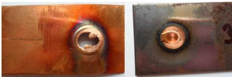
รูปที่ 26 แสดงลักษณะรูปแบบการพังทลายของชิ้นงานทดสอบที่ความเร็วรอบตัวถวน 3000 รอบ/นาที เวลาในการกัดแซ่ 6 วินาที และอัตราป้อน 4 มม./นาที
