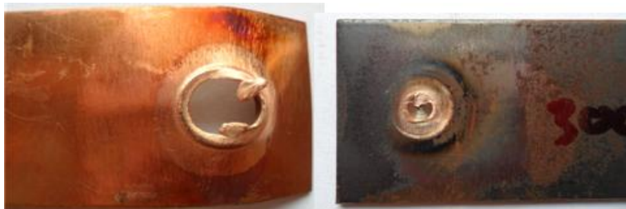
รูปที่ 52 แสดงลักษณะรูปแบบการพังทลายของชิ้นงานทดสอบที่ความเร็วรอบตัวกวน 4000 รอบ/นาที เวลาในการรูดแซ่ 2 วินาที และอัตราป้อน 8 มม./นาที
