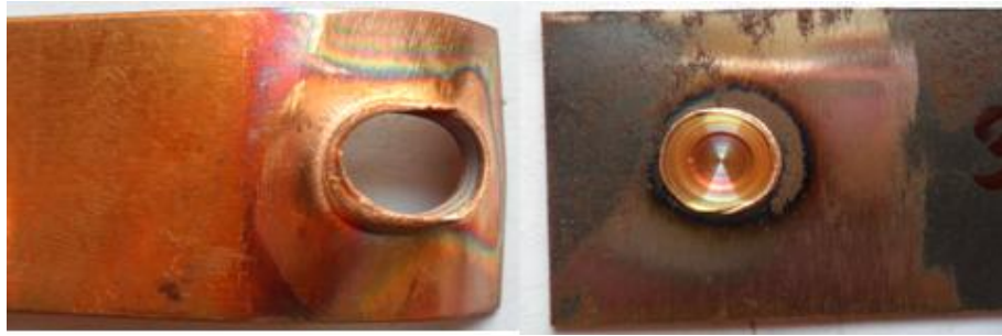
รูปที่ 48 แสดงลักษณะรูปแบบการพังทลายของชิ้นงานทดสอบที่ความเร็วรอบตัวกวน 3500 รอบ/นาที เวลาในการกัดแซ่ 8 วินาที และอัตราป้อน 8 มม./นาที
