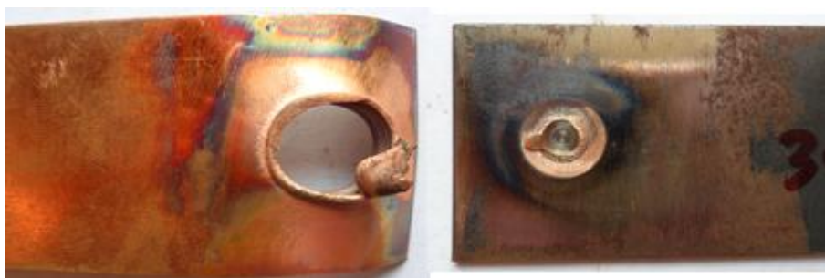
รูปที่ 11 แสดงลักษณะรูปแบบการพังทลายของชิ้นงานทดสอบที่ความเร็วรอบตัวกวน 2500 รอบ/นาที เวลาในการรูดแซ่ 6 วินาที และอัตราป้อน 6 มม./นาที
