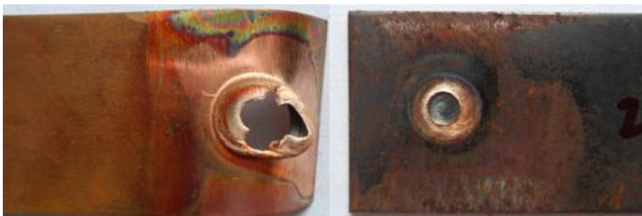
รูปที่ 14 แสดงลักษณะรูปแบบการพังทลายของชิ้นงานทดสอบที่ความเร็วรอบตัวกวน 2500 รอบ/นาที เวลาในการกัดแซ่ 8 วินาที และอัตราป้อน 4 มม./นาที
