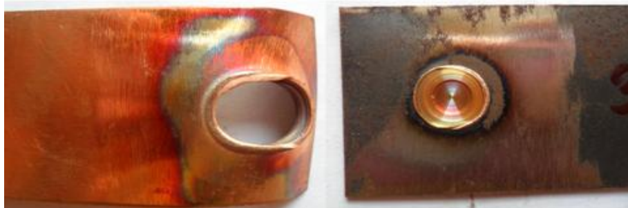
รูปที่ 22 แสดงลักษณะรูปแบบการพังทลายของชิ้นงานทดสอบที่ความเร็วรอบตัวถวน 3000 รอบ/นาที เวลาในการทดสอบ 4 วินาที และอัตราป้อน 4 มม./นาที
