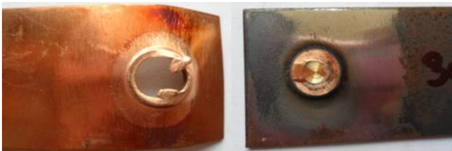
รูปที่ 29 แสดงลักษณะรูปแบบการพังทลายของชิ้นงานทดสอบที่ความเร็วรอบตัวกวน 3000 รอบ/นาที เวลาในการรูดแซ่ 8 วินาที และอัตราป้อน 2 มม./นาที
