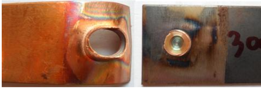
รูปที่ 18 แสดงลักษณะรูปแบบการพังทลายของชิ้นงานทดสอบที่ความเร็วรอบตัวกวน 3000 รอบ/นาที เวลาในการรูดแซ่ 2 วินาที และอัตราป้อน 4 มม./นาที
