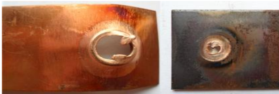
รูปที่ 57 แสดงลักษณะรูปแบบการพังทลายของชิ้นงานทดสอบที่ความเร็วรอบตัวถวน 4000 รอบ/นาที เวลาในการกัดแซ่ 6 วินาที และอัตราป้อน 2 มม./นาที
