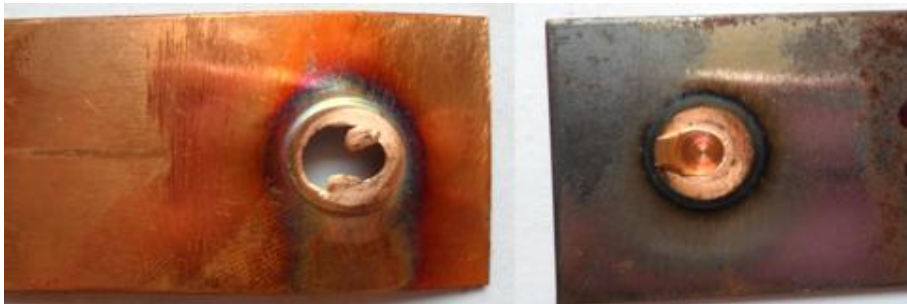
รูปที่ 58 แสดงลักษณะรูปแบบการพังทลายของชิ้นงานทดสอบที่ความเร็วรอบตัวถวน 4000 รอบ/นาที เวลาในการกัดแซ่ 6 วินาที และอัตราป้อน 4 มม./นาที
