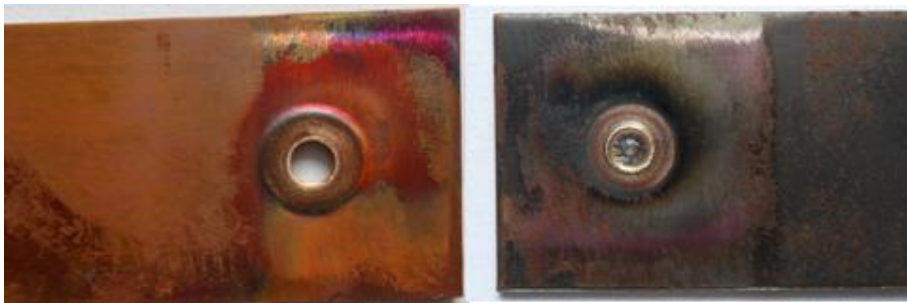
รูปที่ 13 แสดงลักษณะรูปแบบการพังทลายของชิ้นงานทดสอบที่ความเร็วรอบตัวกวน 2500 รอบ/นาที เวลาในการกัดแซ่ 8 วินาที และอัตราป้อน 2 มม./นาที
