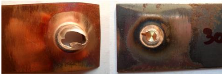
รูปที่ 20 แสดงลักษณะรูปแบบการพังทลายของชิ้นงานทดสอบที่ความเร็วรอบตัวกวน 3000 รอบ/นาที เวลาในการรูดแซ่ 2 วินาที และอัตราป้อน 8 มม./นาที
