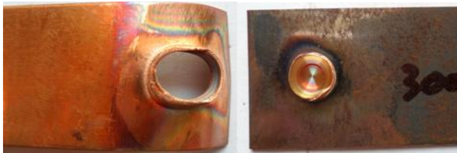
รูปที่ 32 แสดงลักษณะรูปแบบการพังทลายของชิ้นงานทดสอบที่ความเร็วรอบตัวกวน 3000 รอบ/นาที เวลาในการกัดแซ่ 8 วินาที และอัตราป้อน 8 มม./นาที
