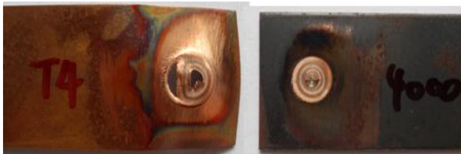
รูปที่ 56 แสดงลักษณะรูปแบบการพังทลายของชิ้นงานทดสอบที่ความเร็วรอบตัวถวน 4000 รอบ/นาที เวลาในการรูดแซ่ 4 วินาที และอัตราป้อน 8 มม./นาที
