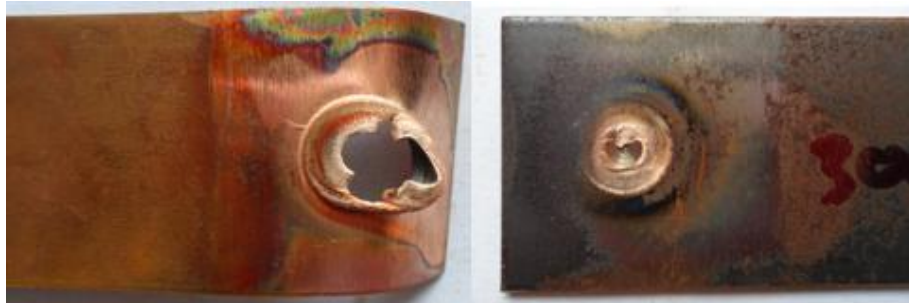
รูปที่ 31 แสดงลักษณะรูปแบบการพังทลายของชิ้นงานทดสอบที่ความเร็วรอบตัวกวน 3000 รอบ/นาที เวลาในการกัดแซ่ 8 วินาที และอัตราป้อน 6 มม./นาที
