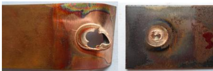
รูปที่ 44 แสดงลักษณะรูปแบบการพังทลายของชิ้นงานทดสอบที่ความเร็วรอบตัวถวน 3500 รอบ/นาที เวลาในการรูดแซ่ 6 วินาที และอัตราป้อน 8 มม./นาที
