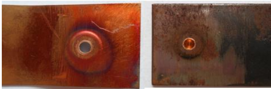
รูปที่ 41 แสดงลักษณะรูปแบบการพังทลายของชิ้นงานทดสอบที่ความเร็วรอบตัวถวน 3500 รอบ/นาที เวลาในการรูดแซ่ 6 วินาที และอัตราป้อน 2 มม./นาที
