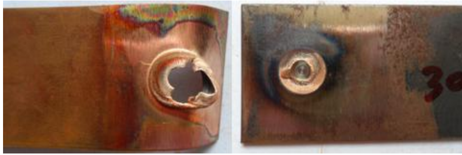
รูปที่ 27 แสดงลักษณะรูปแบบการพังทลายของชิ้นงานทดสอบที่ความเร็วรอบตัวกวน 3000 รอบ/นาที เวลาในการรูดแซ่ 6 วินาที และอัตราป้อน 6 มม./นาที
