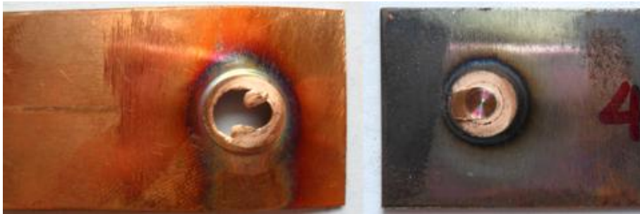
รูปที่ 62 แสดงลักษณะรูปแบบการพังทลายของชิ้นงานทดสอบที่ความเร็วรอบตัวกวน 4000 รอบ/นาที เวลาในการรูดแซ่ 8 วินาที และอัตราป้อน 4 มม./นาที
