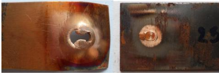
รูปที่ 3 แสดงลักษณะรูปแบบการพังทลายของชิ้นงานทดสอบที่ความเร็วรอบตัวกวน 2500 รอบ/นาที เวลาในการกัดแซ่ 2 วินาที และอัตราป้อน 6 มม./นาที
