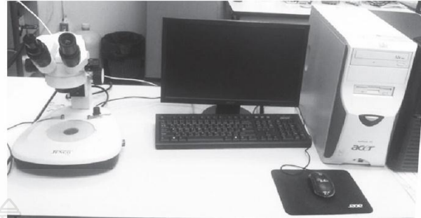
รูปที่ 3.10 อุปกรณ์ที่ใช้สำหรับการตรวจสอบโครงสร้างมหภาค
