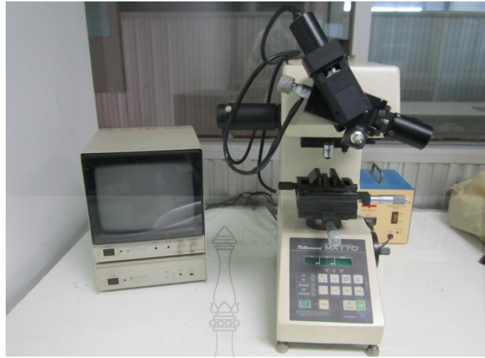
รูปที่ 3.23 เครื่องวัดค่าความแข็ง ยี่ห้อ MATSUZAWA รุ่น MXT70
