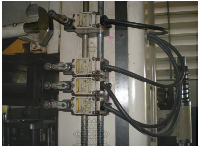
รูปที่ 3.20 การปรับตั้ง (Limit switch) เครื่องปั๊ม
