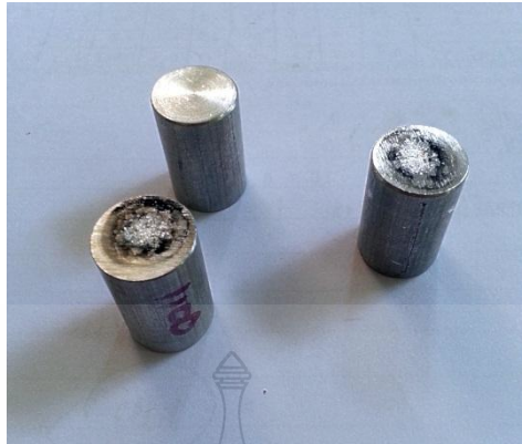
รูปที่ 3.25 ชิ้นงานที่ทำการทดสอบหาส่วนผสมทางเคมี
