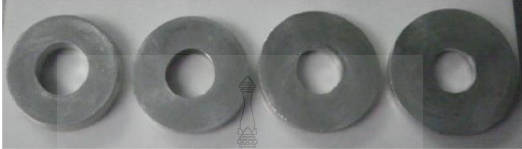
รูปที่ 3.7 รูปแสดงชิ้นงานหลังทดสอบ Ring compression test.
