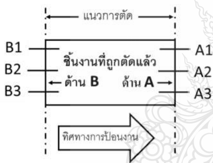
รูปภาพแสดง กระบวนการตัดเฉือน และจุดในการวัดชิ้นงาน
