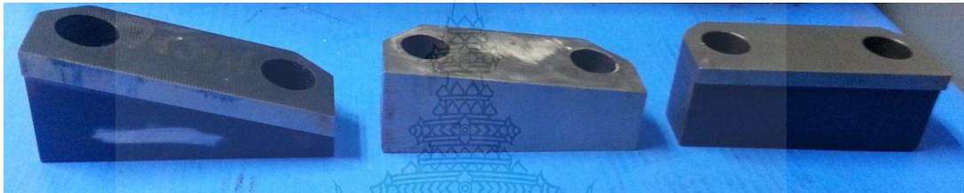
รูปที่ 3.12 คมตัดแม่พิมพ์ตัวล่างที่ระบายเอียงต่างๆ
