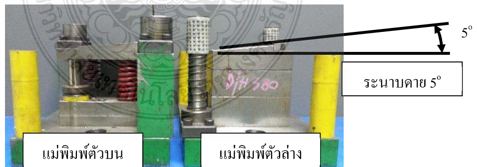
รูปที่ 3.5 ชุดแม่พิมพ์ สำหรับคมตัดตายระนาบ 5 องศา
