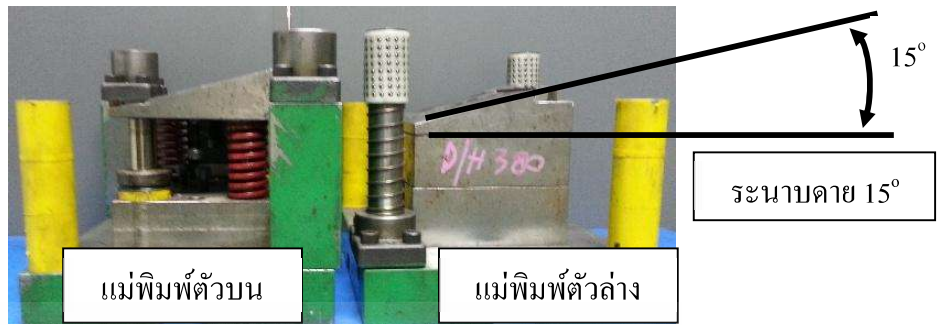
รูปที่ 3.6 ชุดแม่พิมพ์ สำหรับคมตัดคายระนาบ 15 องศา
